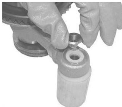
Retirer les bagues d'étanchéité (2) et (7) avec un tournevis.
