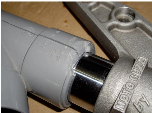
Le montage en place, le circlips de blocage du spi fait juste le bon diamètre pour tenir les deux parties de PVC ensemble. Il n'y a plus qu'à taper sur le haut du bras de fourche.
