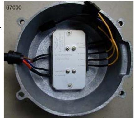
in Lichtmaschinendeckel eingebaut
