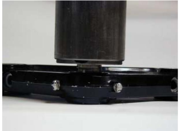
Kegelrollenlager mit Distanzscheibe und aufgesetztem Abzieher
