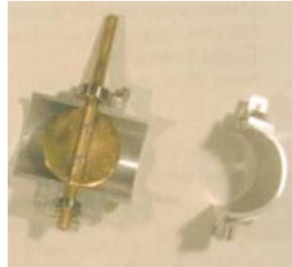
Das Bypassventil für die Leerlauf Luft ist durch eine kegelige Schraube einstellbar. Die dazugehörige Benzinmenge wird in den Kenndaten definiert.
