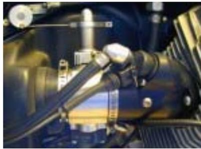
1125-9310 Drosselklappe rechts mit Bosch Potentionmeter zur Positionserfassung
