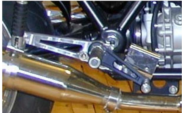
Die Grundplatten sind aus dem Vollen gefräst, die Rasten sind klappbar und mit Gummi belegt. Der Bremshebel und die Getriebeanlenkung sind gefräst, die Hebel sind aus Aluminium-Druckguß. Die Hebel sind schwarz eloxiert.
