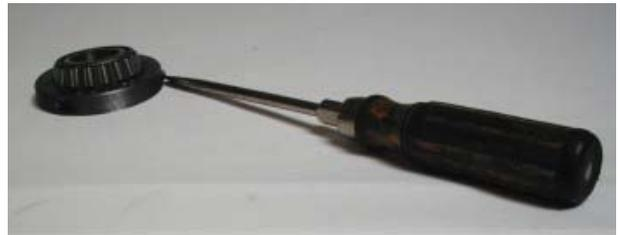
Schraubenzieher mit Klauen und Kegelrollenlager
