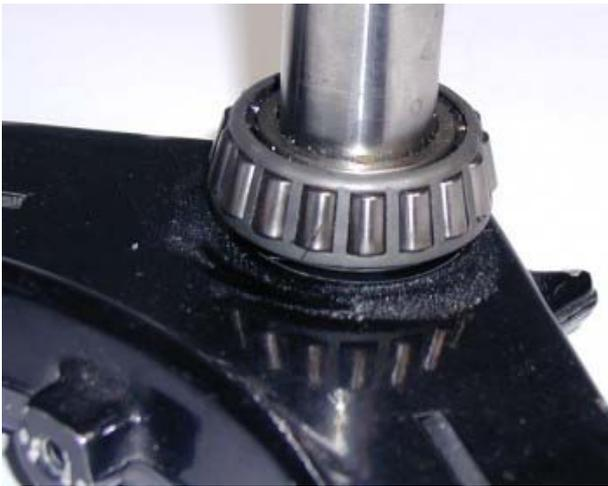
Kegelrollenlager mit Gummi- und Distanzscheibe
