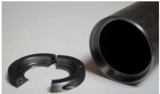
Geöffnete Klauen mit Abziehrohr Gewinde M66x1
