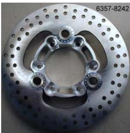
**Bremsscheibe hinten** schwimmend, rostfrei. Als Ersatz für die Serien-6-Loch Bremsscheibe. Die Bremsscheibe wird komplett montiert mit 3 Floatern und Flanschen (Aluminium gefräst) ausgeliefert. Die Floater und Seegerringe sind aus V2A, die Federn glanzverchromt. Verwendung für: LM1, LM2, LM3, T3, T4, alle SP, Cal.2 als Ersatz für die originale hintere Bremsscheibe.
