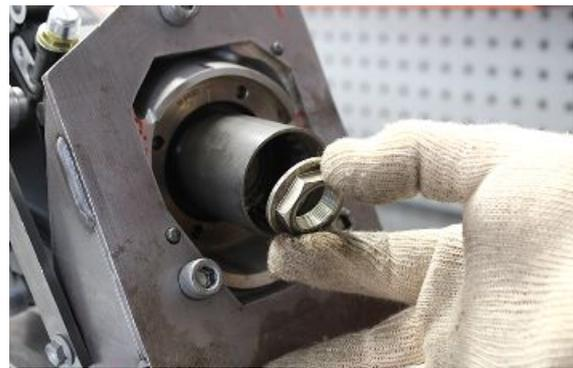
Die Flanschnutter zur Befestigung des Ritzels mit dem vorgegebenen Drehmoment anschrauben.
