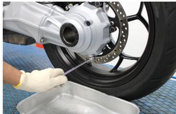
Die Einfüllschraube (2) abschrauben und entfernen.
