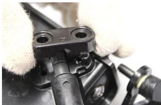
Nach dem Einsetzen der Blende und vor dem Wiederanbringen der Innenabdeckung das Gehäuse der 2 Unterlegscheiben entsprechend fetten.
