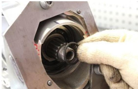
Den Öldichtring vom Gewinding entfernen.
