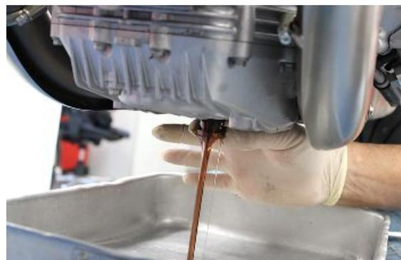
Nach Abfluss des Öls, die Ablassschraube mit der zugehörigen Unterlegscheibe anschrauben und mit dem vorgesehenen Drehmoment anziehen. Die am Magneten der Ölabblassschraube anhaftenden Metallreste entfernen.
