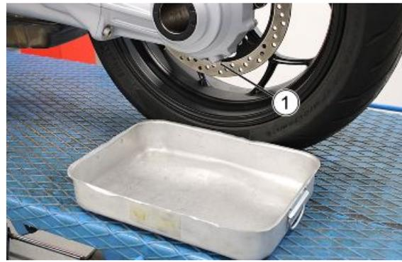
Die Ölablassschraube lösen, ohne sie zu entfernen.
