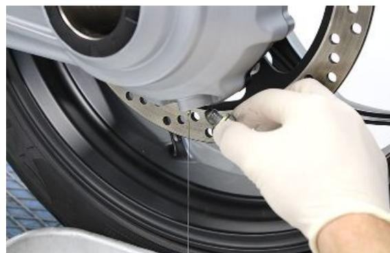
Nach Abfluss des Öls, die Ablassschraube mit der zugehörigen Unterlegscheibe anschrauben und mit dem vorgesehenen Drehmoment anziehen. Die am Magneten der Ölablassschraube anhaftenden Metallreste entfernen.
