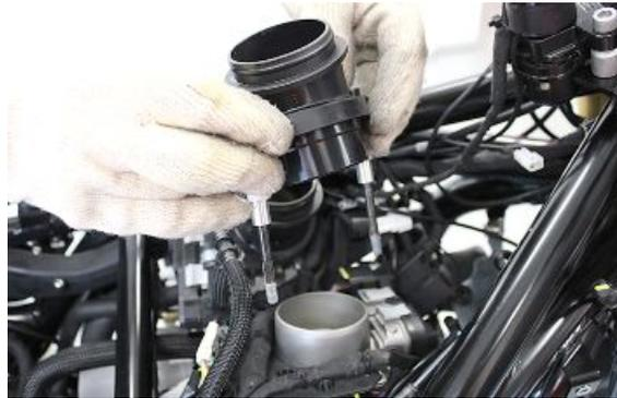
Die Befestigungsschrauben der Ansaugleitung links abschrauben.
