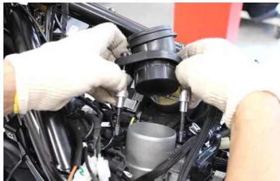
Die zwei Kabelstecker der Steuergeräte der Drosselkörper trennen, dazu auf die entsprechende Lasche einwirken.
