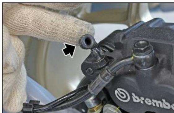
schlauch und den Schraubenschlüssel entfernen.
