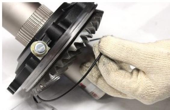
Die Zackung des Kegelradpaars beim Einbau schmieren.
