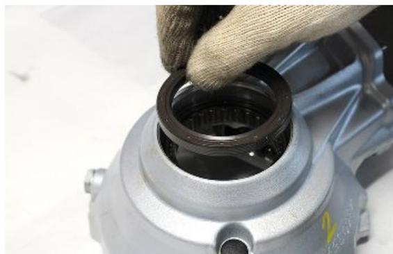
Mit dem Spezialwerkzeug die Nadelhülse aus dem Getriebegehäuse entfernen.
