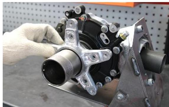
Den Bügel des Spezialwerkzeugs am Flansch anbringen.
