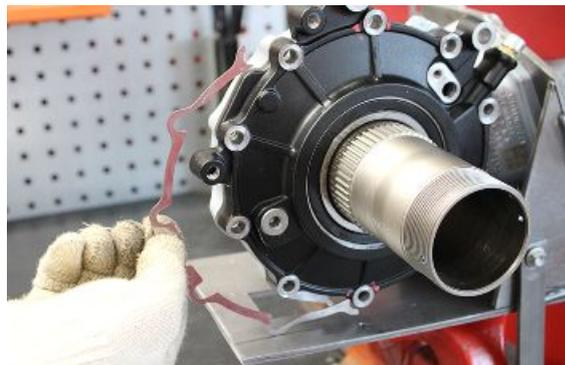
Die Zahnkranznabe komplett mit Deckel vom Getriebegehäuse entfernen.
