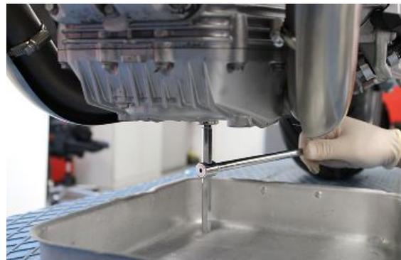
Die Ablassschraube entfernen und einige Minuten Öl in den Behälter tropfen lassen.
