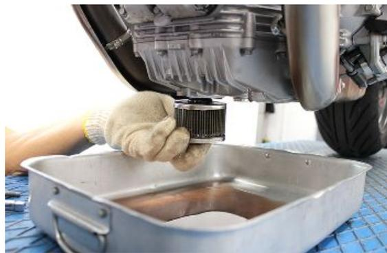
Den Deckel mit der Feder nach unten gerichtet wieder einbauen.
