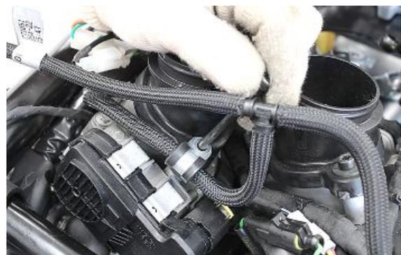
Die Befestigungsschrauben der Ansaugleitung rechts abschrauben.
