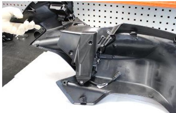
Die Innenverkleidung komplett mit Halterungen und Stellvorrichtung entfernen.
