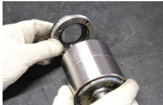
Mit dem Spezialwerkzeug den Gewinding auf dem Ritzel einsetzen.
