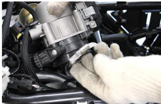
Die Befestigungsschelle des Drosselkörpers an der Motormuffe anschrauben.
