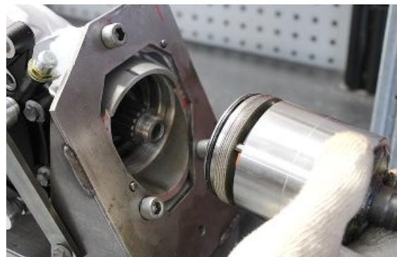
Mit dem Spezialwerkzeug den Gewinding mit dem vorgegebenen Drehmoment anschrauben.
