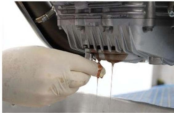
Den Motorölfilterdeckel mit der Feder entfernen.
