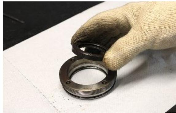
Einen neuen Öldichtring in den Gewinding einsetzen.
