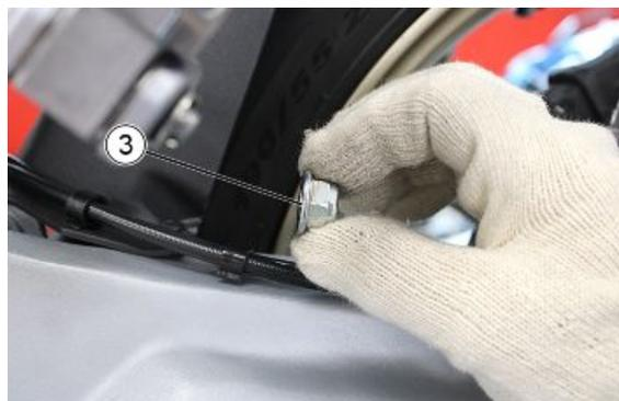
Die hintere Mutter (3) festhalten und die Schraube (4) mit vorgegebenem Drehmoment anziehen.
