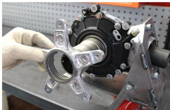
Den Bügel des Spezialwerkzeugs am Flansch anbringen.
