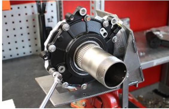
Leicht mit einem Gummihammer auf den Deckel vom Gehäuse trennen, so dass die Entfernung der Distanzscheiben möglich ist.
