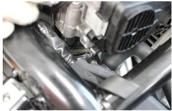
Die zwei Kabelstecker der Steuergeräte der Drosselkörper verbinden, dazu auf die entsprechende Lasche einwirken.
