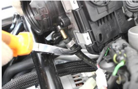
Den Kabelstecker des Luftdruck-/temperatursensors verbinden.
