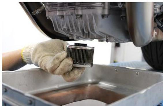
Beim Wiedereinbau einen neuen O-Ring zur Dichtung des Motorölfilterdeckels verwenden
