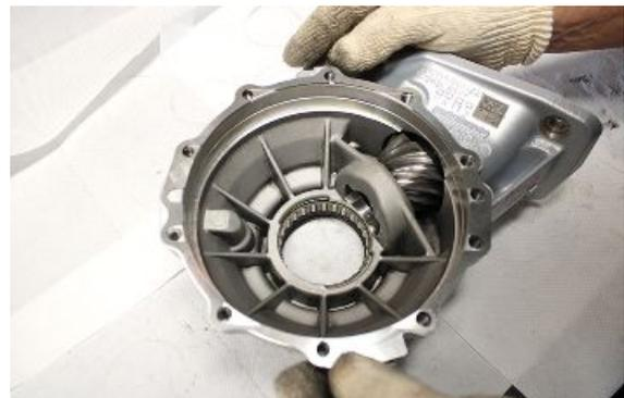
Die Zahnkranznabe komplett mit Deckel in das Getriebegehäuse einsetzen.
