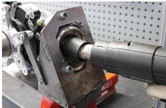
Die Flanschmutter zur Befestigung des Ritzels lösen.
