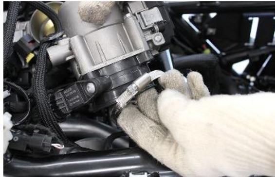
Den Kabelstecker des Luftdruck-/temperatursensors abtrennen.
