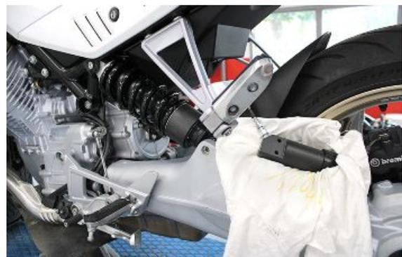
Die hintere Mutter (1) festhalten und die Schraube (2) entfernen.
