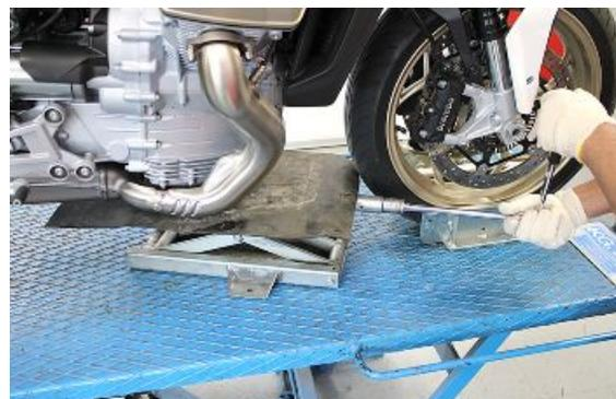
Die Befestigungsschrauben des vorbefüllten Tanks am Haltebügel abschrauben.
