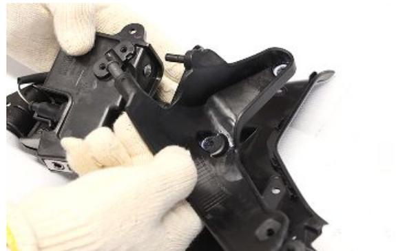
Die Befestigungsschrauben der Baugruppe der Stellvorrichtung von der anderen Halterung abschrauben.
