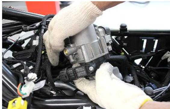
Die Halteschelle der Motormuffe am Drosselkörper positionieren.
