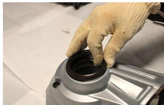
In den Getriebegehäusedeckel einen neuen Dichtring einsetzen und sicherstellen, dass er bis zum Anschlag gebracht wird unter Verwendung eines Gummihammers.
