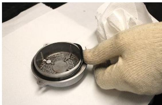
Den neuen Motorölfilter einsetzen.
