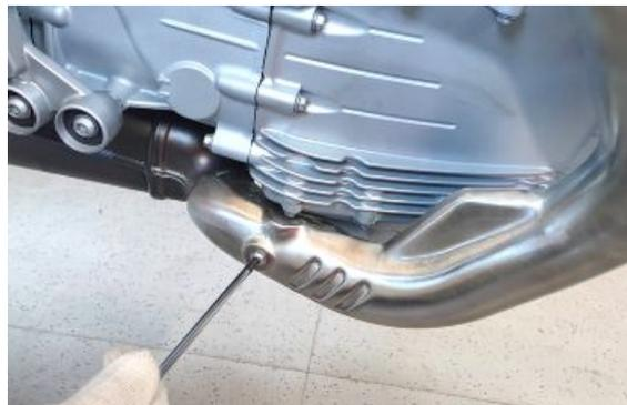
Die obere Schelle die sich im Inneren des Hitzeschutz befindet, abschrauben.
