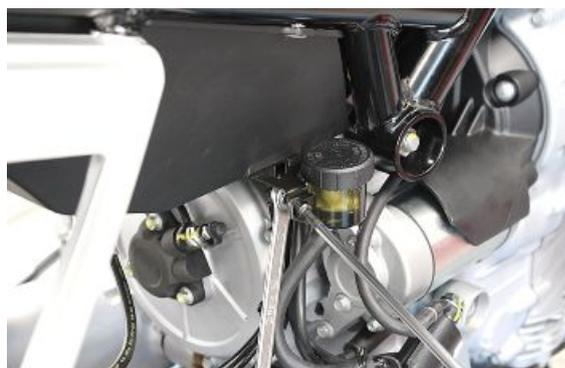
Die Gummischelle zur Befestigung der hinteren Bremsleitung entfernen.
