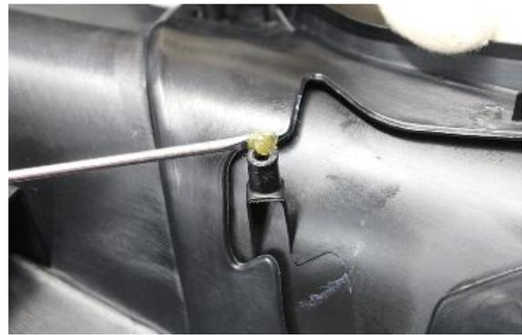
Die 2 Unterlegscheiben in die entsprechenden Sitze auf der Blende positionieren, dann die Innenabdeckung befestigen.
