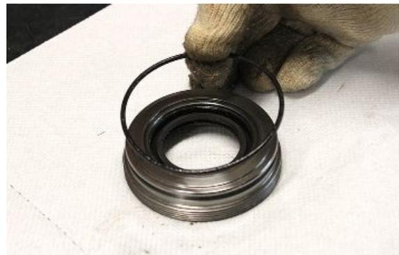
Den mit dem Spezialwerkzeug gelieferten Flansch an der Radnabe einsetzen und bis zum Anschlag am Gehäusedeckel Ibringen.
