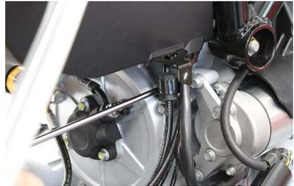
Die Befestigungsschraube des Sitzbankträgers so abschrauben und entfernen, dass er vom Rahmen getrennt wird.
