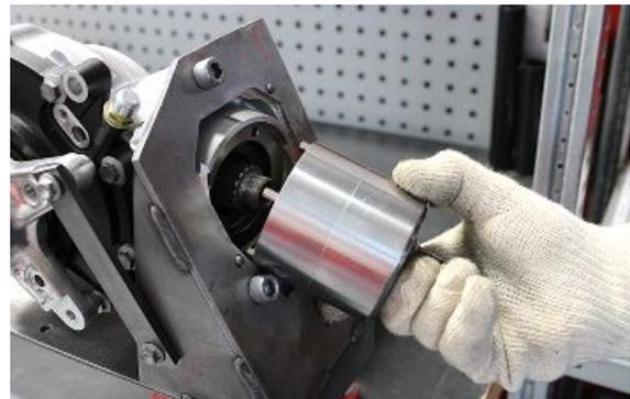
Sicherstellen, dass das Spezialwerkzeug bis zum Anschlag an den Gewinding gebracht wird.
