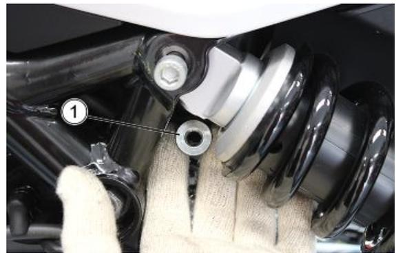
Die hintere Mutter (1) festhalten und die Schraube (2) mit vorgegebenem Drehmoment anziehen.
