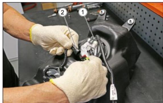
Der Kraftstoffstandsensord variiert seinen Widerstand abhängig von der Position des entsprechenden Schwimmers, der im Benzin im Tank eingetaucht ist. Das Signal wird vom Armaturenbrett gelesen, dass es in eine sichtbare Information für den Fahrer übersetzt.
