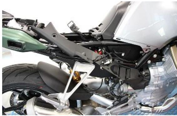
Den ersten Stecker des Kabelbaums des elektronischen Steuergeräts der Aufhängung abziehen.
