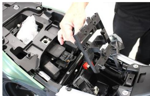
Das Seitenteil rechts entfernen und die darunterliegende Innenverkleidung abziehen.
