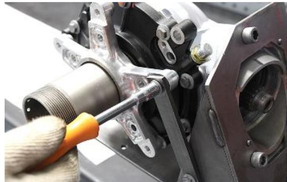
Den mitgelieferten Flansch mit dem Spezialwerkzeug von der Zahnkranznabe entfernen.
