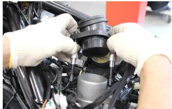
Die Befestigungsschrauben der Ansaugleitungen anschrauben.
