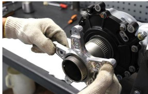
Die Befestigungsschrauben der Getriebegehäuseabdeckung lösen.
