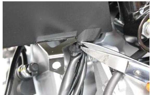
Den zweiten Stecker des Kabelbaums des elektronischen Steuergeräts der Aufhängung vom Sitzbankträger abziehen.
