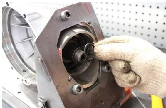
Einen neuen O-Dichtring in den Gewinding einsetzen und sicherstellen, dass er bis zum Anschlag gebracht wird.
