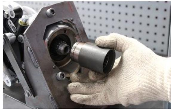
Den Sitz des Gewinderings mit einem Luft-Heizstrahler erhitzen.
