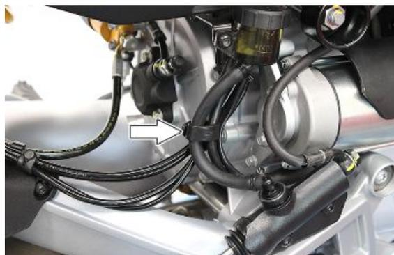
Den Ölbehälter der Hinterradbremse entfernen., dazu die entsprechende Befestigungsschraube abschrauben.
