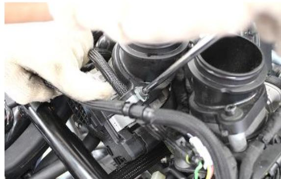
Die Befestigungsschraube der Metallschelle, mit denen der Leitung direkt am Kraftstofftank gehalten werden, abschrauben.
