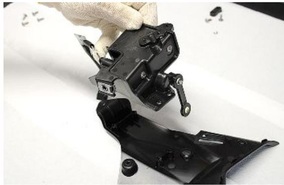
Die Befestigungsschrauben der Baugruppe der Stellvorrichtung von der Stellvorrichtung-Halterung abschrauben.
