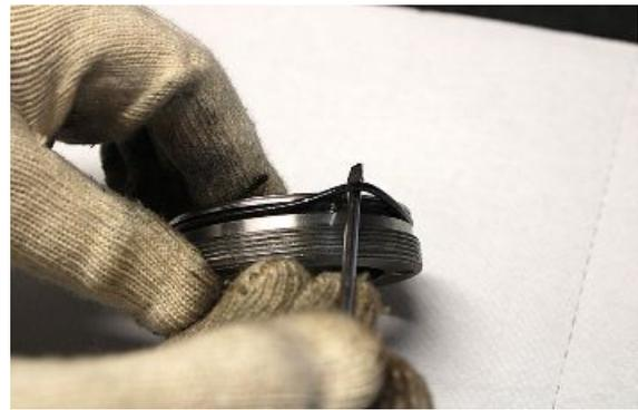
Den Dichtungsring aus dem Gewinding herausziehen, indem mit einem geeigneten Schlagdorn darauf geschlagen wird.
