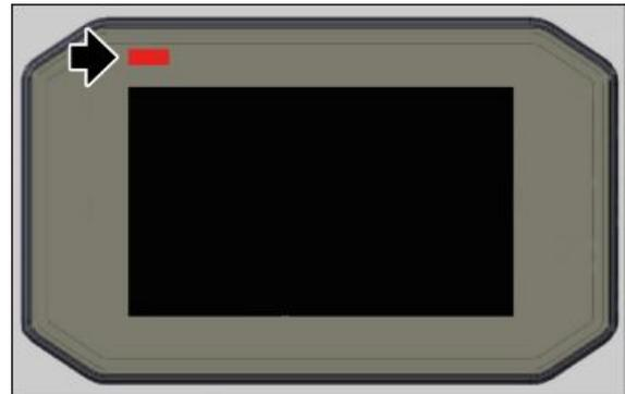
Tritt beim Starten eine Störung an der Wegfahrsperre auf, wird zur Eingabe der Kunden-Kennziffer aufgefordert. Ist die Kennziffer richtig eingegeben, wird die Störung am Armaturenbrett durch Anzeige des Symbols SERVICE und Aufleuchten der roten Haupt-Warnleuchte angezeigt.
