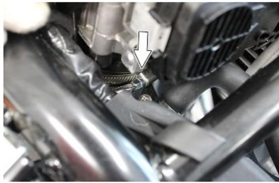
Den Drosselkörper und die Befestigungsschelle anheben.
