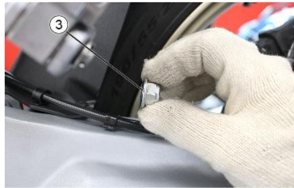
Den Stoßdämpfer samt vorbefülltem Tank herausziehen.
