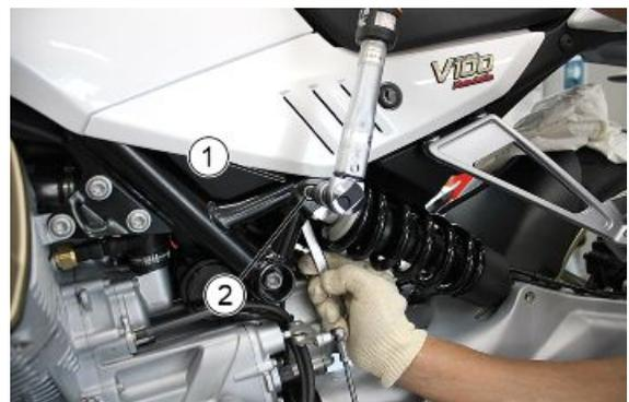
Den vorgefüllten Tank auf den Haltebügel aufsetzen und die Befestigungsschrauben mit vorgegebenem Drehmoment anziehen.
