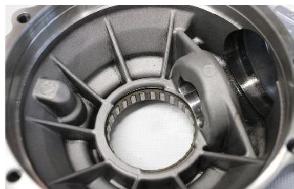
Das Getriebegehäuse umdrehen und Fett zwischen der Nadelhülse und dem Sitz des Dichtungsringes auftragen.
