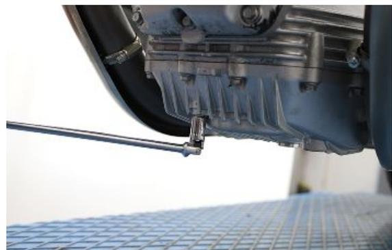
Einen Behälter mit angemessenem Fassungsvermögen unter den Motorölfilterdeckel anbringen und die 3 Befestigungsschrauben vollständig lösen.
