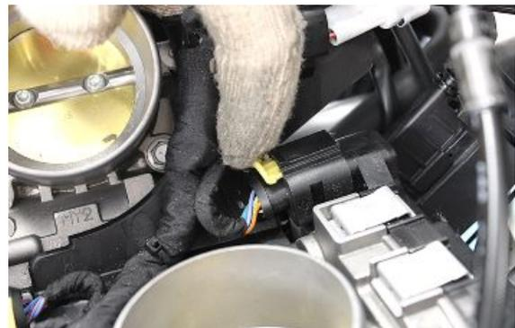
Die beiden Kabelstecker der Steuerelektronik der Drosselkörper trennen.
