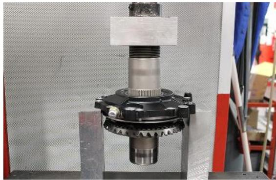
Den Dichtring vom Getriebegehäusedeckel herausziehen.
