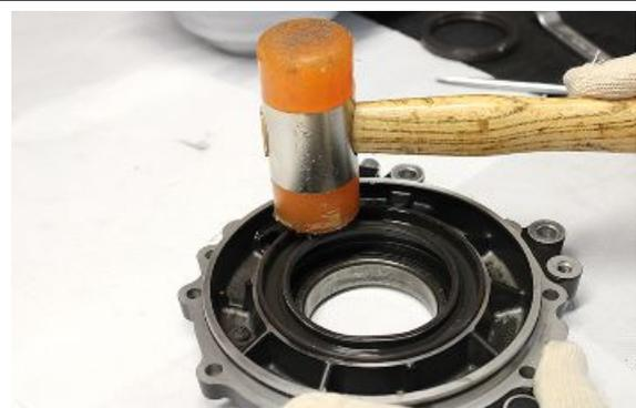
Den Deckel des Getriebegehäuses auf der Zahnkranznabe einsetzen.
