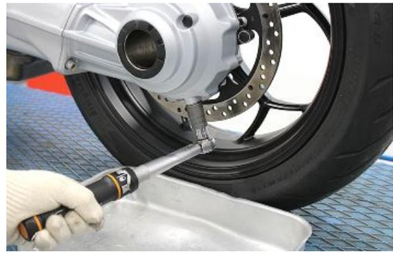
Mit einer geeigneten Spritze neues Öl durch den Einfüllstutzen einfüllen.
