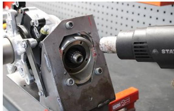
Um den Gewinding zu entfernen mit dem Spezialwerkzeug die entsprechenden Stifte in die Bohrungen des Gewinderings einführen.
