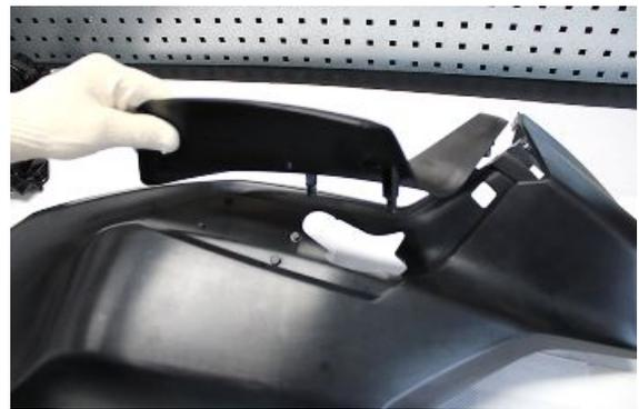
Falls erforderlich, die pilzförmigen Gummis aus der Verkleidung entfernen.
