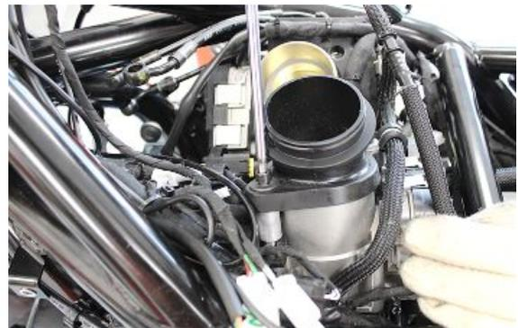
Die Befestigungsschraube der Metallschelle einsetzen, mit denen der Leitung direkt am Kraftstofftank gehalten werden.
