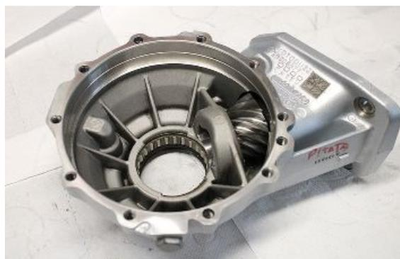
Die erste Distanzscheibe auf der Passfläche mit dem Deckel anbringen und mit dem Profil des Gehäuses ausrichten.
