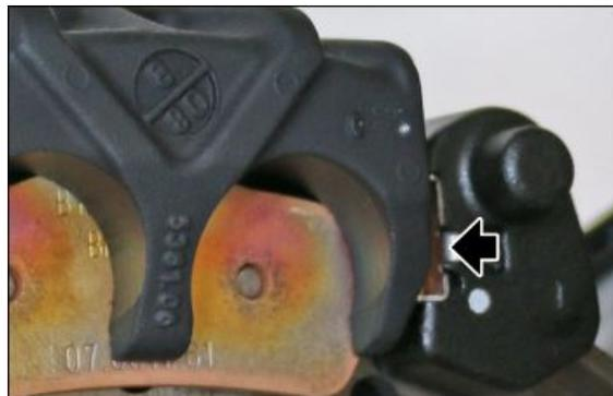
**SICHERSTELLEN, DASS DER VORDERE TEIL DER BREMSBELÄGE KORREKT IN DEN ENTSPRECHENDEN SITZ DER BREMSSELNHALTERUNG EINGESETZT WIRD.**
