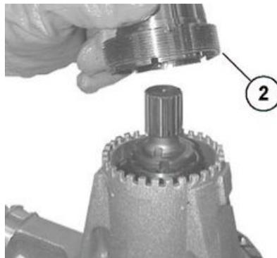
Den Gewinding (2) mit dem Spezialschlüssel (s4) mit dem vorgesehenen Drehmoment festschrauben.
