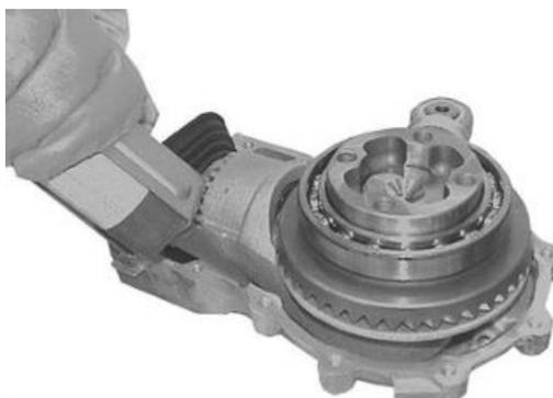
Einen neuen Dichtungsring mit dem Puffer einbauen.
