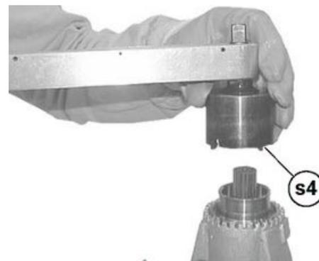
Den Gewinding (2) ausbauen und den Dichtungsring vom Gewinding abnehmen.
