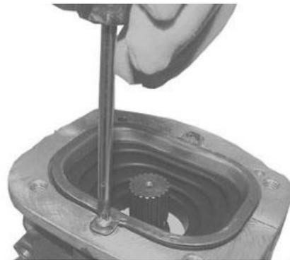
Die Öl-Einfüllschraube zusammen mit der Unterscheibe anbringen.
