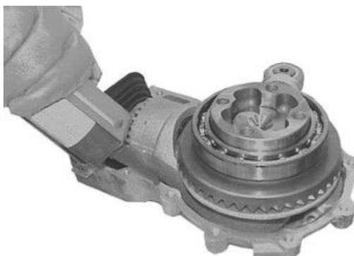
Einen neuen Dichtungsring mit dem Puffer einbauen.
