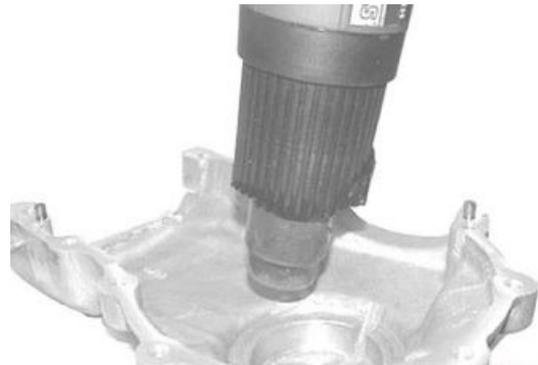
Die Halterungseinheit in das Gehäuse einsetzen.
