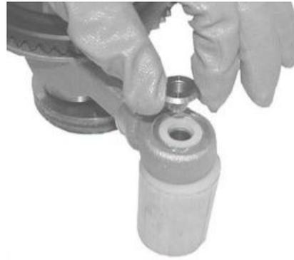
Die Dichtungsringe (2) und (7) mit einem Schraubenzieher entfernen.
