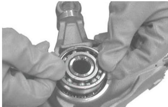
**Einbau der Gehäuseeinheit**
