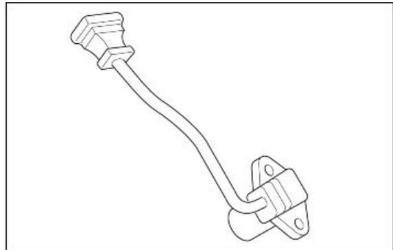
Das Kontrollverfahren am Kabelstecker des Sensors und am Kabelstecker A (BRAUN) an der Einspritz-Zündelektronik vornehmen: Wenn nicht ok, wiederherstellen. Wenn ok, den Stromdurchlass an den beiden Kabeln zu den PIN 25 und 35 am Kabelstecker der Zündelektronik prüfen. Ist kein Stromdurchlass gegeben, das Kabel wiederherstellen. Ist Stromdurchlass gegeben, den Sensor auf Unterbrechung prüfen und auswechseln.
