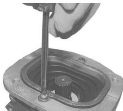
Die Öl-Einfüllschraube zusammen mit der Unterlegscheibe anbringen.
