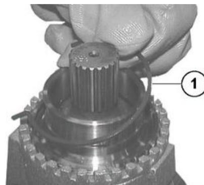
Einbauposition des Sicherungsrings (1).
