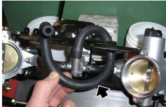
Das kürzere Teil der Kraftstoffleitung, das an der Drosselkörpern angeschlossen ist, muss rechts angebracht werden.
