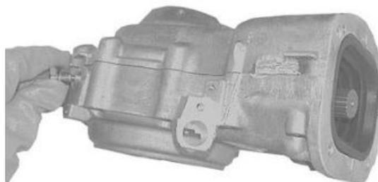
Die Öl-Ablassschraube zusammen mit der Unterlegscheibe anbringen.
