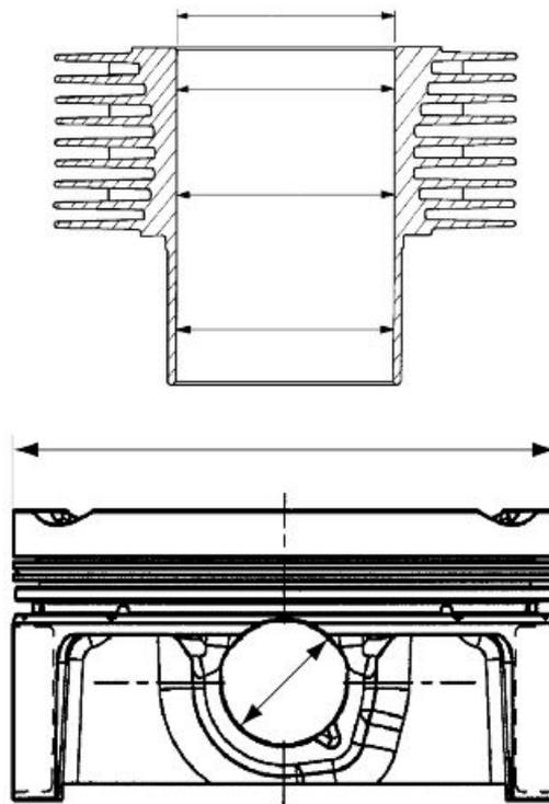
**EINBAUSPIEL KOLBENBOLZEN - KOLBEN**
