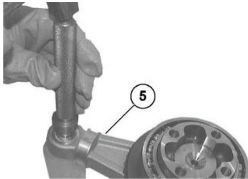
Den Sicherungsring (3) mit einer geeigneten Zange an der Halterung (5) anbringen.
