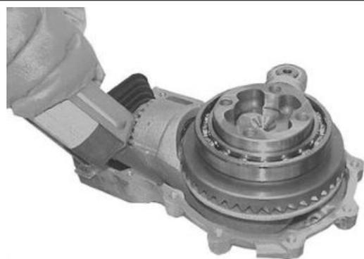
Einen neuen Dichtungsring mit dem Puffer einbauen.
