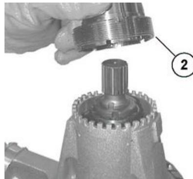
Den Gewinding (2) mit dem Spezialschlüssel (s4) mit dem vorgesehenen Drehmoment festschrauben.
