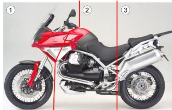
Die Verteilung der Stromkabel wird in drei Hauptbereiche unterteilt (siehe Abbildung).
