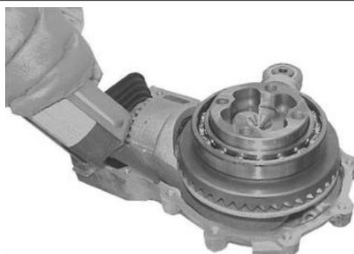
Einen neuen Dichtungsring mit dem Puffer einbauen.
