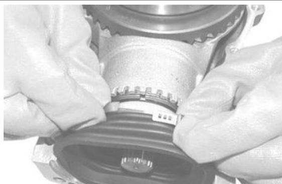
Die Schelle mit der entsprechenden Zange festziehen.
