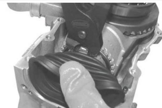
Das vorgeschriebene Dichtungsmittel am Gehäuse anbringen.
