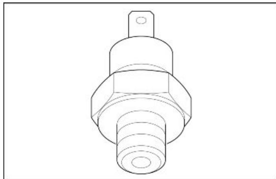
oletten Kabel zwischen Kabelstecker Sensor und PIN 17 Kabelstecker Armaturenbrett ausführen: Wenn nicht ok, das Kabel wiederherstellen, wenn ok, den Sensor austauschen.
