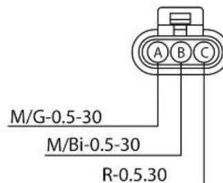
**IN DEN BEREICHEN DER ELEKTRISCHEN ANLAGE GIBT ES ZEICHNUNGEN DER KABELSTECKER. DARAUF ACHTEN, DASS DIE ZEICHNUNGEN DEN KABELSTECKER/DAS BAUTEIL VON DER KABELSEITE BETRACHTET DARSTELLEN, D. H. VON DER SEITE DES HAUPTKABELBAUMS, DER IN DEN KABELSTECKER/DAS BAUTEIL GEFÜHRT WIRD.**
