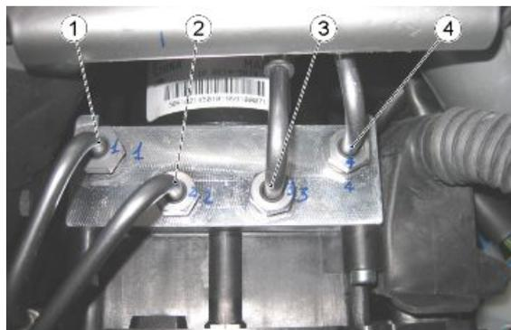
**Hinweis: Zunächst die Bremsleitungen, die von der ABS-Steuerelektronik zum Bremszylinder laufen (1-4), trennen, und die offenen Anschlüsse ABS-Steuerelektronik sofort mit Schutzdeckeln versiegeln.**
