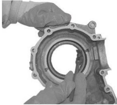
Die Zentrier-Stiftschrauben mit M8-Gewinde in die Gewindebohrungen am Gehäuse einsetzen (siehe Abbildung).
