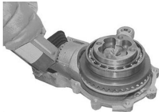
Einen neuen Dichtungsring mit dem Puffer einbauen.
