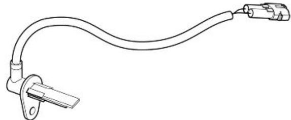
Falls die Verkabelung keine Schäden aufweist, bedeutet das, dass der Geschwindigkeitssensor defekt ist oder der Kreis zwischen Sensor und Kabelstecker unterbrochen ist. Den Geschwindigkeitssensor austauschen.
