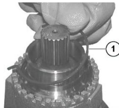
Einbauposition des Sicherungsrings (1).
