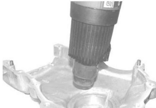
Die Halterungseinheit in das Gehäuse einsetzen.
