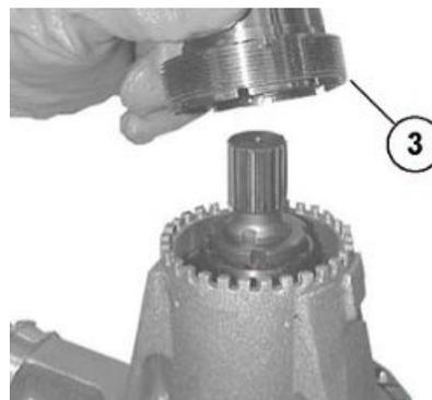
Den Dichtungsring (3) mit dem Puffer (2) CA715855 (siehe F.1) und einem Hammer in den Gewinding einsetzen.
