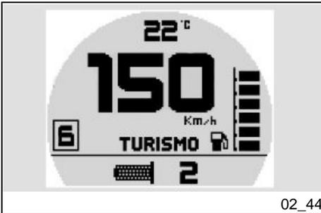
Es gibt 3 Wärmestärken und diese werden zyklisch (von der Stufe 1 zur Stufe 3) bei jedem kurzen Druck auf den Schalter aktiviert. Nach der Stufe 3 wird mit einem weiteren kurzen Druck auf den Schalter die Funktion ausgeschaltet.
