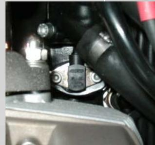
Comme toutes les résistances, ce capteur aussi est sujet à la température de fonctionnement. Sa valeur optimale est déterminée par le fabricant, pour fonctionner correctement, même à des températures supérieures à 20°, il ne devra pas dépasser 20% de sa valeur nominale.
