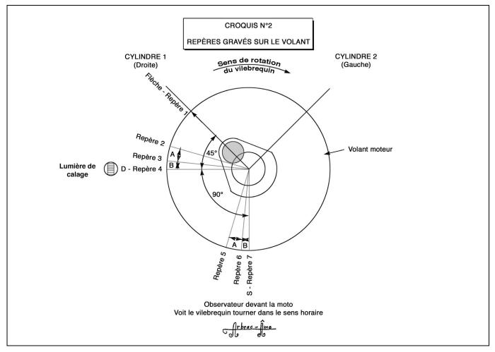
Sur le volant moteur, d'un diamètre de 230 mm, sont implantés les repères suivants, dans le sens d'apparition dans la lumière de calage :
