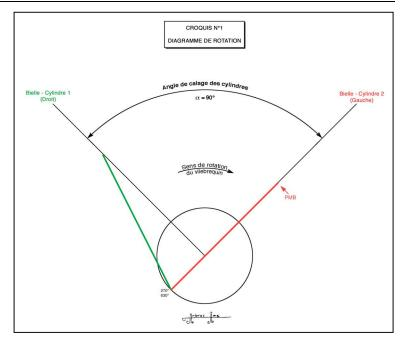
Dans ce premier tour, le cylindre 1 est en phases admission + compression ; le cylindre 2 est en phases allumage + détente + échappement.
