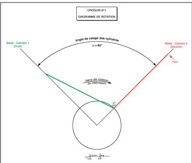
3. À la position 180°, la bielle 1 est à son PMB tandis que la bielle 2 est partie vers son PMB. Le cylindre 1 est en fin d'admission et le cylindre 2 est en cours de détente.
