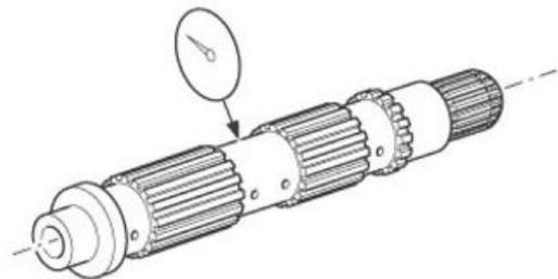
Controlar la presencia de picaduras y desgaste en los engranajes de la transmisión y, eventualmente, sustituir los engranajes defectuosos.
