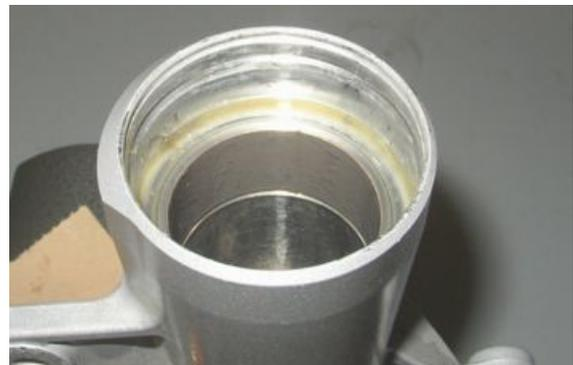
Si se encuentran signos de excesivo desgaste o daños, sustituir el componente afectado.
