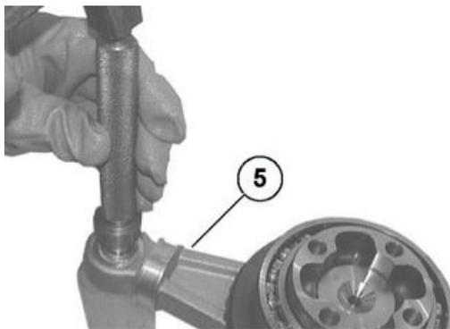
Montar en el soporte (5) el anillo de bloqueo (3) con una pinza adecuada.
