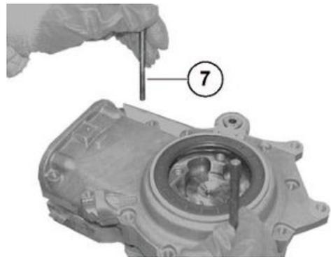
Ensamblar los tornillos de fijación (7).
