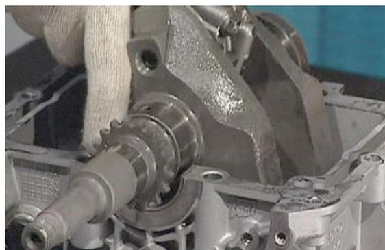
En el bloque motor superior desenroscar el sensor de presión de aceite y extraer el casquillo de retención del árbol de levas, luego extraer el árbol y los taqués, clasificándolos.
