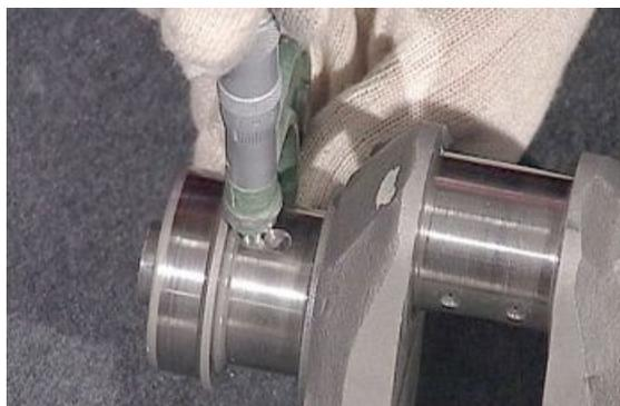
Desviación máxima del paralelismo de los dos ejes del cigüeñal (perno de biela y pernos de banco lado volante y lado distribución) no debe superar los 0,02 mm (in 0.0009), a la distancia de 40 mm (in 1.5748).
