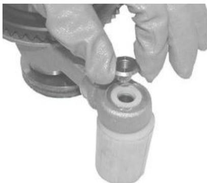
Retirar los anillos de estanqueidad (2) y (7) con un destornillador.
