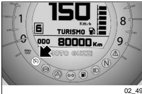
Una vez alcanzada la velocidad deseada, el sistema se podrá activar (paso a estado SET) mediante una presión breve de la tecla Cruise Control, en las siguientes condiciones:
