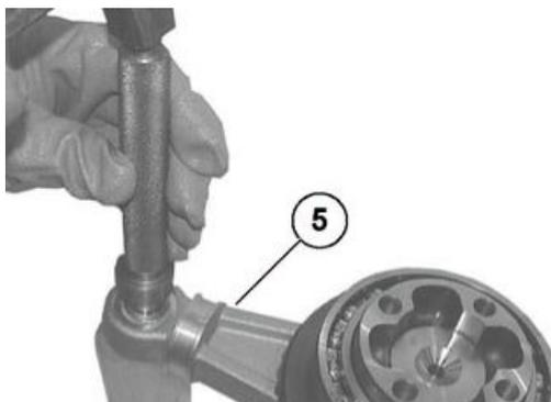
Montare nel supporto (5) l'anello d'arresto (3) con una pinza adatta.
