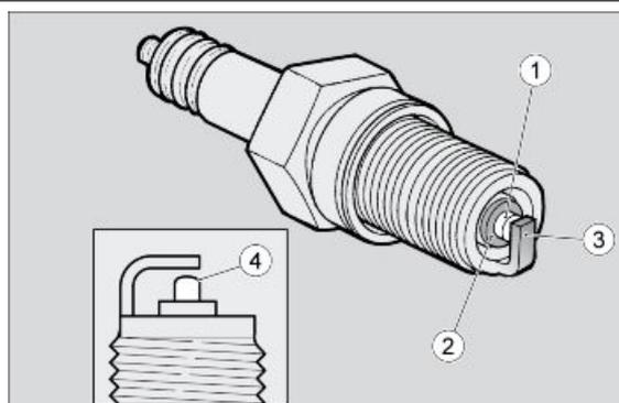
Se la candela presenta screpolature sull'isolante, elettrodi corrosi, eccessivi depositi o elettrodo centrale (1) con la sommità arrotondata (4), deve essere sostituita.
