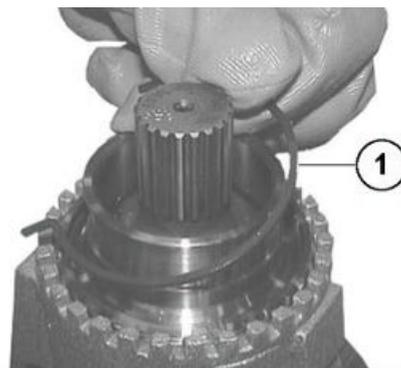
Posizione di assemblaggio dell'anello d'arresto (1).
