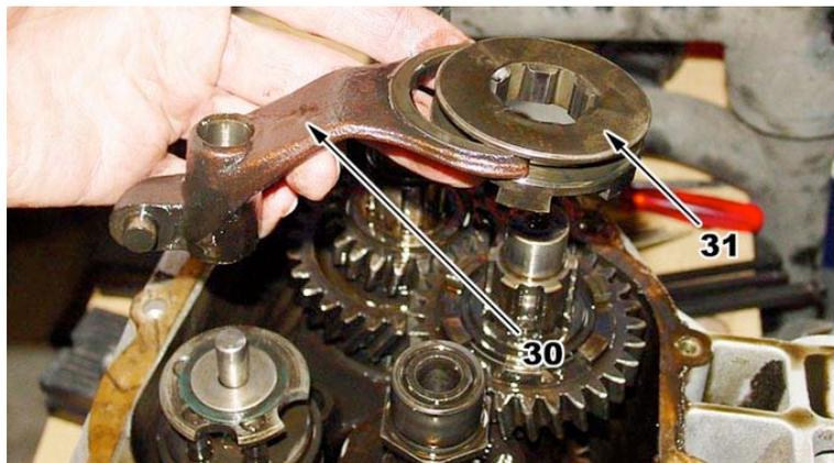
(32) À l'aide d'un tournevis long ou d'un crochet, dégager les 2 autres fourchettes de leurs logements sur le tambour de sélection.
