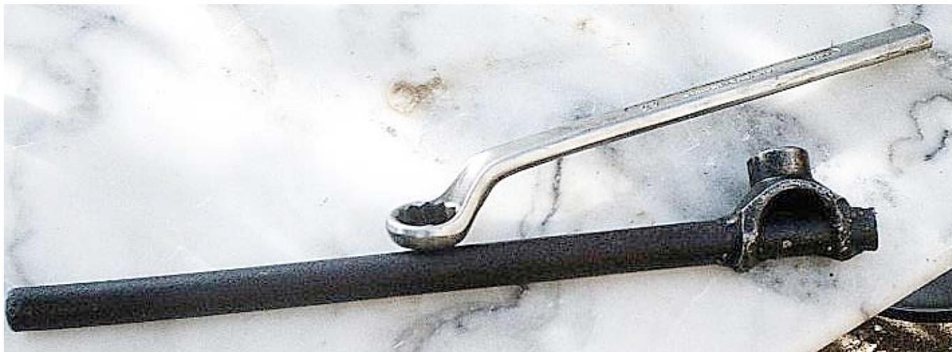
Le démontage s'effectuera de préférence en bloquant la clé à œil **et** la boîte de vitesses car la clé a peu de prise sur l'écrou et dérape facilement. C'est donc avec l'outil cannelé qu'on va démonter : pour cela, il "visser" (sens des aiguilles d'une montre) l'arbre secondaire car ce n'est pas l'écrou que l'on tourne, mais l'arbre.
