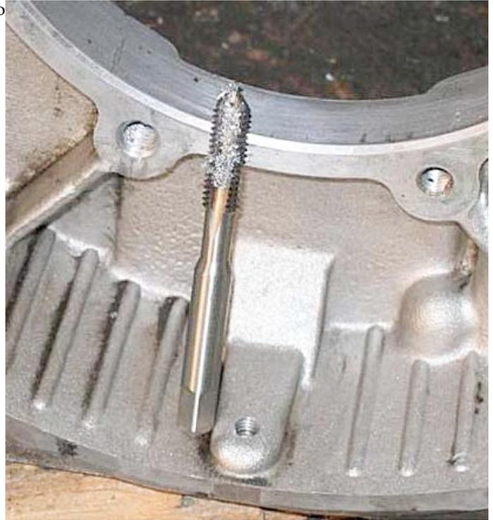
On ébavure aussi le palier AR et sa portée sur le bloc, car l'alu s'était collé à quelques endroits.
