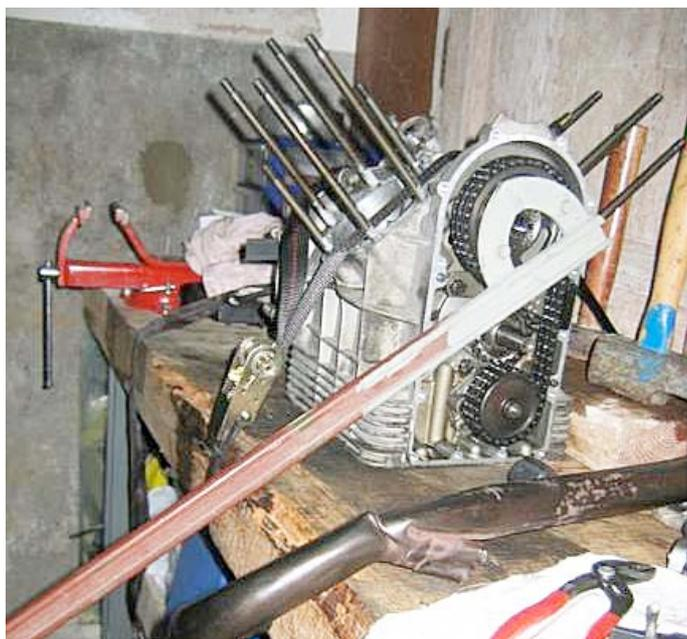
Ci-dessous, l'écrou de blocage du pignon de vilebrequin qui se dépose avec une clé à ergot spéciale: il est placé avec sa partie biseautée en appui vers l'intérieur. C'est le sens normal. En le mettant à l'envers on accrocherait les languettes de la rondelle frein lors du serrage. Dans cet état, inutile de le réutiliser...
