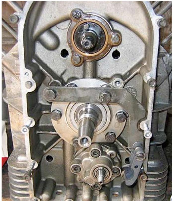
La pose de la chaîne est fastidieuse, avec les trois ergots des pignons qui doivent être en face de ceux des axes, et les deux traits des pignons d'AàC et de vilebrequin alignés. C'est sûrement beaucoup plus facile à deux. Remarquez à droite la position correcte du tendeur...
