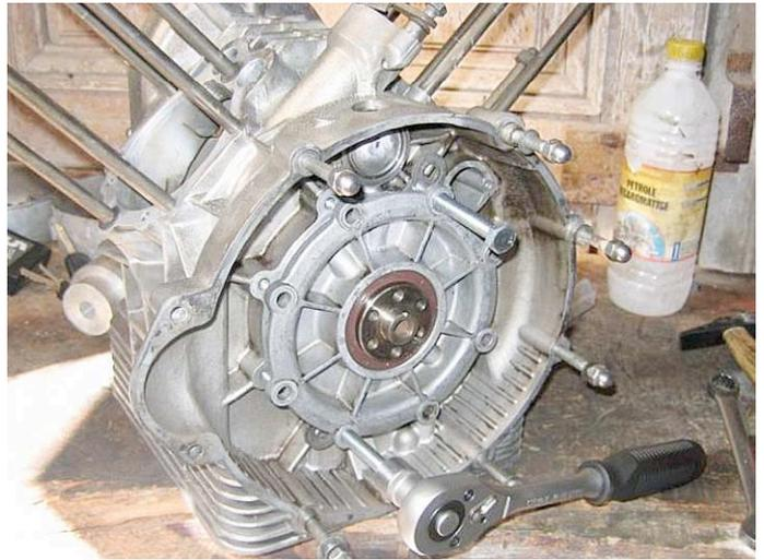
Les vis d'extraction peuvent attaquer le carter et défoncer le début du filet. Aussi, une fois le carter un peu décollé, il est préférable de placer une rondelle pour servir d'appui plus large.
