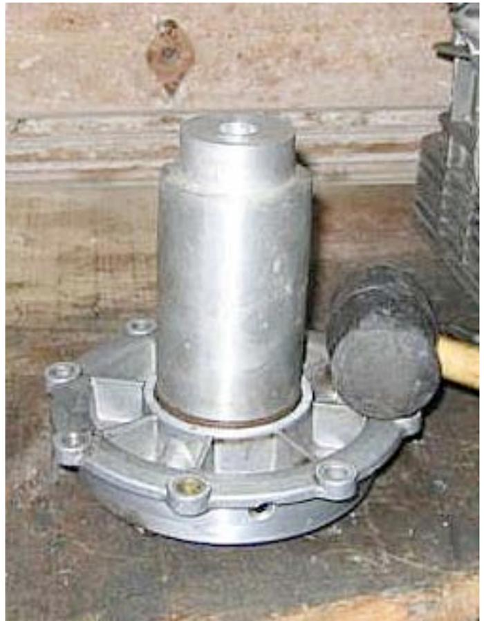
En l'absence de couple spécifique, les vis de 8 des paliers se serrent à 25 à 30 Nm. Ne pas oublier de mettre le joint. Les vis du palier d'AàC, en 6, se serrent à 10 Nm environ, en une seule passe.
