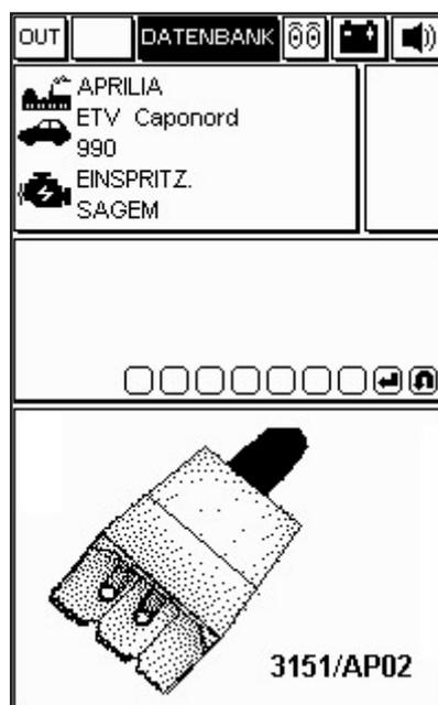
Schließen Sie das Adapterkabel an die Autodiagnosebuchse der Steuereinheit an, wie in der Abbildung auf dem Display dargestellt, indem Sie das angegebene Verbindungskabel verwenden.
