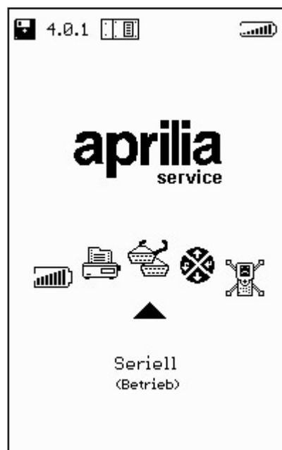
Ermöglicht die Ausführung eines Übertragungs-/Empfangstests, um den korrekten Betrieb der seriellen Anschlüsse zu prüfen.
