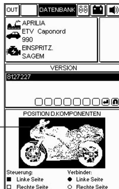
Nachdem Sie alle Markierungen bestätigt haben, erscheint im Diagnosefenster das Bild des Adapterkabels, das als Schnittstelle zwischen Motordiagnosekabel des Motorrads und Hauptkabel 3151/AP01 verwendet werden muss, mit der
