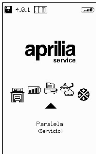
Permite la ejecución de un test de transmisión/recepción con el objetivo de verificar el correcto funcionamiento del puerto paralelo.
