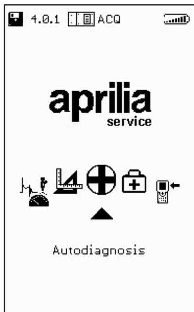
Utilizando las teclas flecha de desplazamiento horizontal se hacen deslizar los iconos del instrumento / función para seleccionar y se pulsa la tecla de confirmación (INTRO).
