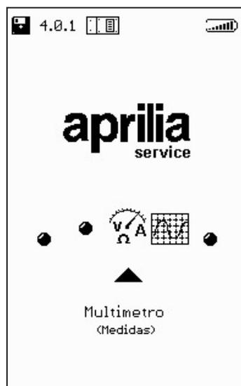
NOTA La función multímetro permite efectuar medidas de: tensión, corriente y resistencia. La medida de la corriente, concretamente, prevé distintas escalas de medida: para las capacidades de hasta 2A (fondo escala) se pueden utilizar los cables originales del kit; para las capacidades de 20A a 600A es necesario utilizar la pinza amperimétrica.
