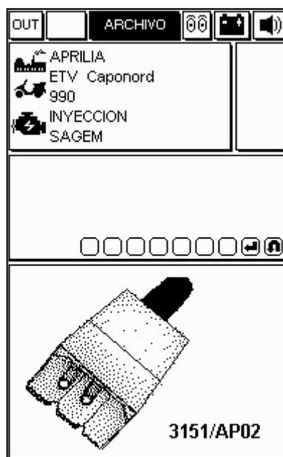
Conecte el cable adaptador a la toma autodiagnos de la centralita tal como se indica en la figura de la pantalla, utilizando el cable conexión recomendado.
