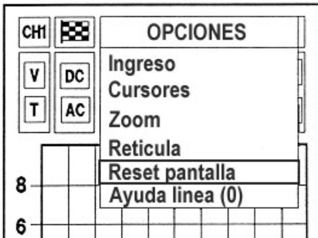
Para seleccionar la función Reset pantalla sitúese en la función correspondiente y a continuación, pulse INTRO. La señal o las señales memorizadas en la pantalla se borrarán, restableciendo la pantalla inicial.
