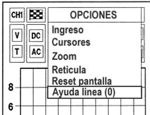
Para seleccionar la función Ayuda línea (0) sitúese en la función correspondiente y a continuación, pulse INTRO. Entrará en una página que describe las operaciones que deberá efectuar para cambiar de posición a la línea del potencial cero. Dicha función permite visualizar partes de la señal que de otro modo estarían cortadas.
