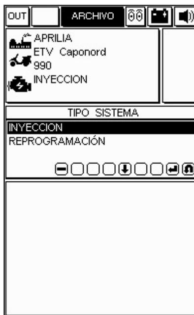
En el ejemplo propuesto, se selecciona el sistema de inyección y a continuación, se pasa al tipo / código centralita y se confirma con INTRO. Se proporciona la versión y la ubicación de la toma.
