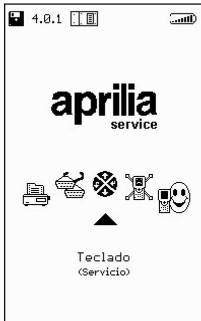
Permite la ejecución de un test para verificar el correcto funcionamiento de cada una de las teclas.
