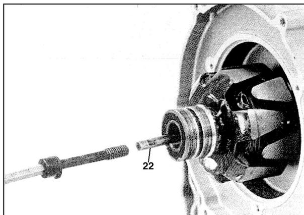
Nannan, le filetage dans le vile est en 8 ainsi que le filetage intérieur du rotor; la vis de fixation du rotor est en filetage 8 avec le corps en 6, c'est elle que l'on visse dans le rotor (après avoir mis cette fameuse pige) pour le pousser.
