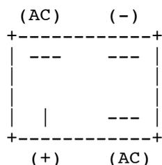
*Donc si j'ai bien suivi, je shunte les deux cosses (AC) ensemble et au régulateur et les deux cosses (+) et (-) ensemble et à la batterie via fusible 30A.*
