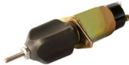
090297 Shut Down Solenoid 24V 24 V., 1.1 Amp., 7-11 Newtons169 Newtons107 Newtons
