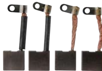
140340 Brush Set Replacing: TAJ102 12 V., L. 14.00, Th. 6.00, H. 16.00
