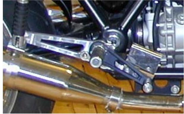
Die Grundplatten sind aus dem Vollen gefräst, die Rasten sind klappbar und mit Gummi belegt. Der Bremshebel und die Getriebenanlenkung sind gefräst, die Hebeleien sind aus Aluminium-Druckguß. Die Hebel sind schwarz eloxiert.
