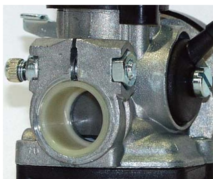
Detailbild des Klemmanschlusses am SHA 15 15 Vergaser.
