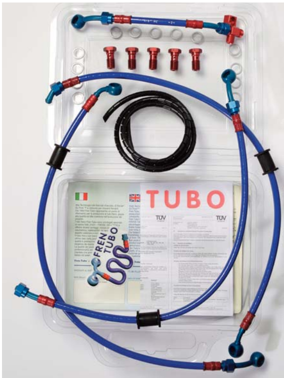
Leitung-Kit Typ 3 Kevlarleitung, Leitungsanschlüsse aus Aluminium
