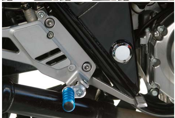
Beispiel für 4 verschiedene Positionen mit einer 23 mm Varioplatte und einer blauen Master Grip Fußraste.
