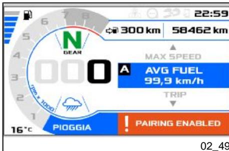
Auf dem Digitaldisplay erscheint die Meldung zur Bestätigung der Freigabe zur Kopplung mit dem Smartphone. Die Bluetooth-Suche auf dem Smartphone aktivieren, das Gerät "BT-ROUTER" auswählen, wenn erforderlich das Passwort "0000" eingeben und auf Verbinden drücken.
