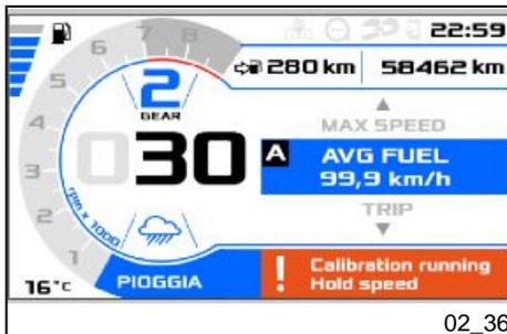
Zum Kalibrieren des MGCT-Systems (Moto Guzzi Control Traction) ca. 10 Sekunden lang auf einem ebenen geraden Straßenabschnitt im zweiten Gang mit einer Geschwindigkeit von 30 +/- 2 km/h (18.64 +/- 1.24 mph) fahren, bis die Meldung "Calibration running Hold speed" auf dem Digitaldisplay erscheint.
