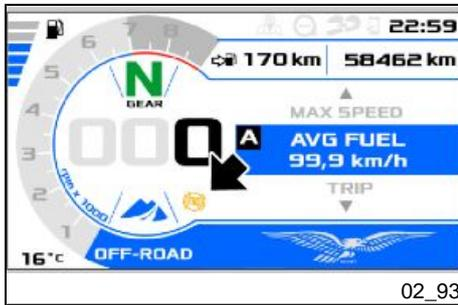
Im Modus **OFF ROAD** wird das ABS-System für das Hinterrad automatisch deaktiviert.
