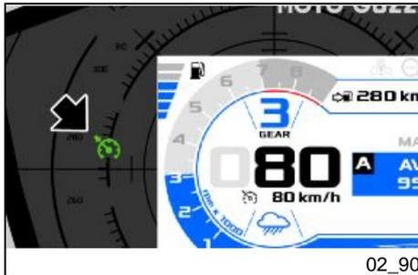
Die Geschwindigkeitsregelanlage ist ein elektronisches System, das die Beibehaltung einer ausgewählten Geschwindigkeit ermöglicht.
