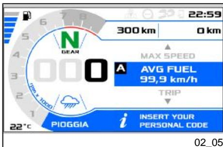
Das Armaturenbrett ist mit einem Wegfahrsperrsystem ausgestattet, welches das Starten sperrt, wenn vom System kein vorher gespeicherter Schlüssel erfasst wird.
