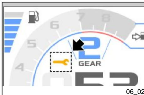
Die Tabelle der planmäßigen Wartung bezieht sich auf den Einsatz auf der Straße. Bei Verwendung der neuen sportlichen V85, greift bei starker Beanspruchung auf anspruchsvollen Strecken, und um die tatsächliche Verschlechterung des Motoröls korrekt zu überwachen, ein elektronisches Gerät ein, das die Leistung des Motors aufzeichnet und Vorhersagen über die Notwendigkeit der Wartung ermöglicht.
