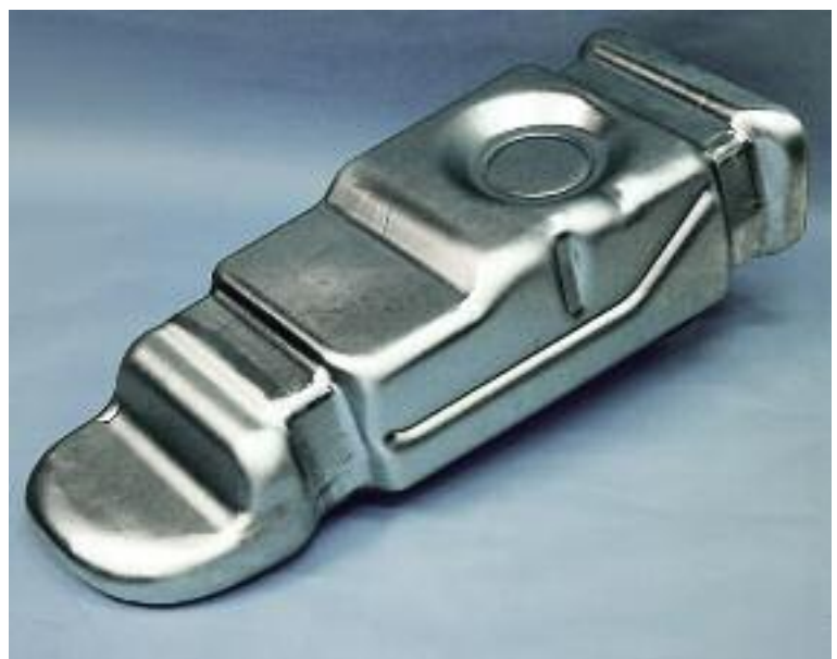
Figure 21 : L'inox est de plus en plus utilisé pour les réservoirs de carburant. Les fixa- tions qui les tiennent en place assurent l'isolation électrique à la jonction.
