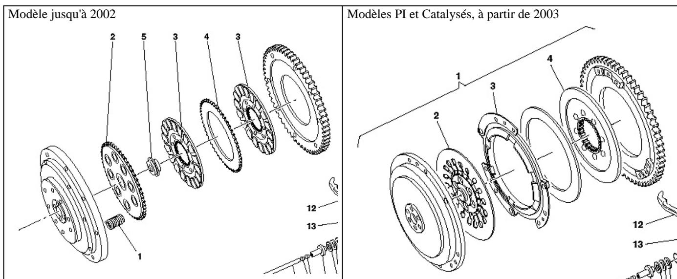
D'après ce qu'on peut comprendre, les 8 ressorts (1) et le plateau de pression (2) sont remplacés par un disque "Belleville" (2).
