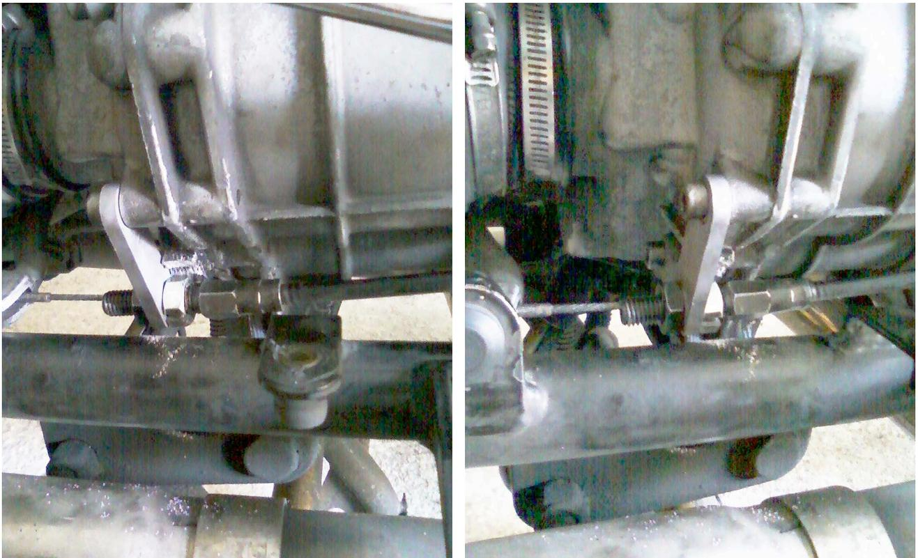
On notera qu'il faut à présent 2 écrous pour bloquer le réglage de la garde car la plaque n'est pas filetée.
