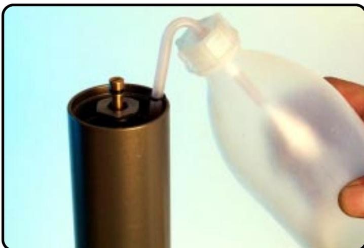
Maintenez l'extrémité de la tige du piston juste au niveau du bord du tube externe (complètement comprimé).
