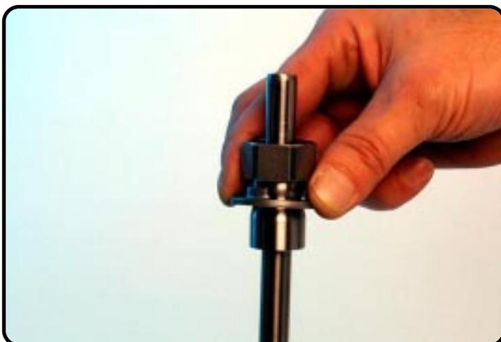
Remplacez la douille à vis et la coupelle d'appui.
