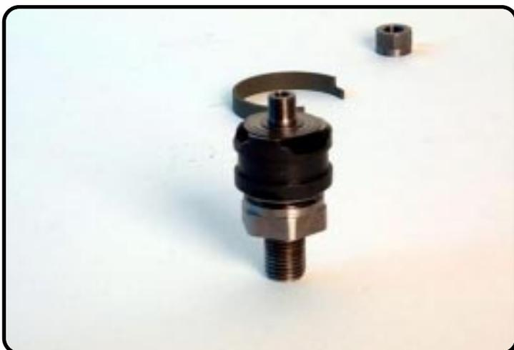
Serrez l'écrou jusqu'à un couple de 5Nm.
