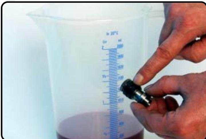
Graissez le joint torique avec de l'huile de fourche avant.
