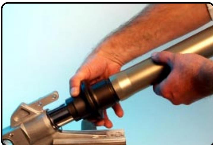
Insertion en tapotant du joint spy dans le tube externe.
