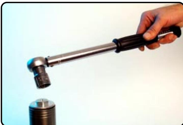
Placez la jambe de fourche dans le bloc de serrage et serrez le couvercle jusqu'à un couple de 25Nm.
