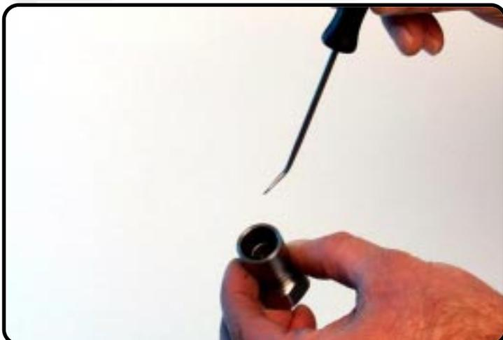
Sortez le caoutchouc de butée de la douille à vis.
