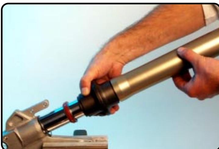
Insertion en tapotant de la bague DU dans le tube externe.
