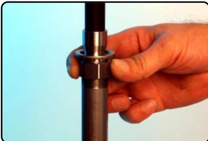
Placez la douille à vis sur le tube.
