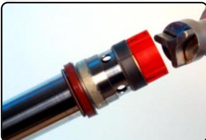
Démontez l'anneau plastique de la bague DU avec T614. (Fourche avant 4054)
