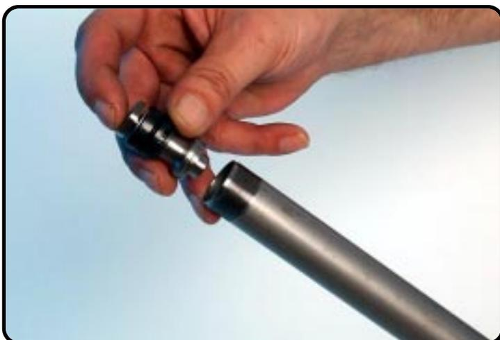
Placez le clapet de compression équipé dans le tube.
