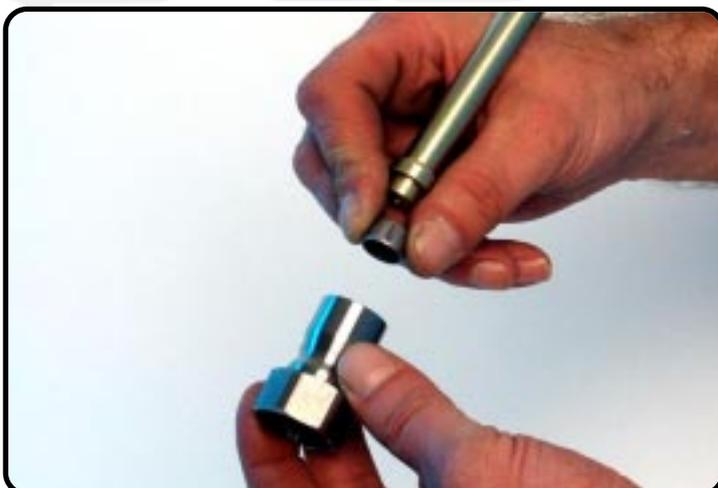
Enfoncez la bague DU dans la douille à vis.
