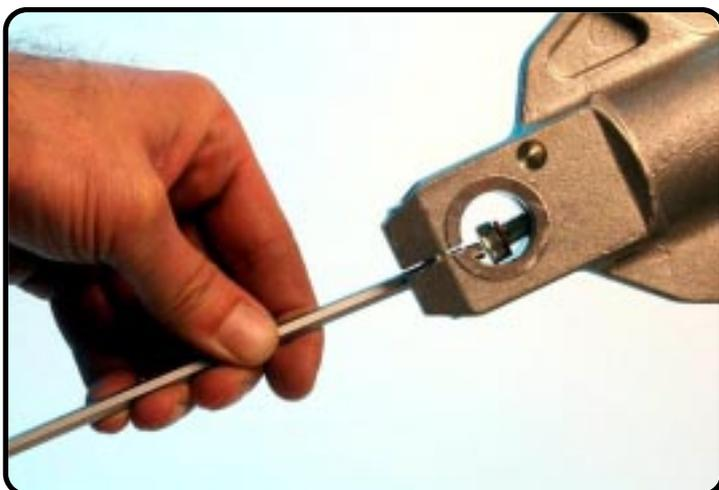
Vissez le boulon avec une nouvelle rondelle en cuivre.
