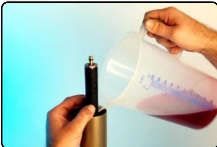
Serrez la jambe de fourche (support d'axe) dans l'étau et remplissez la jambe de fourche d'huile jusqu'à ce qu'elle affleure le bord du tube externe. Maintenez le tube externe vertical.
