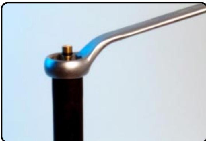
Serrez la tige du piston de l'autre coté et dévissez la butée équipée. (dimension 22)
