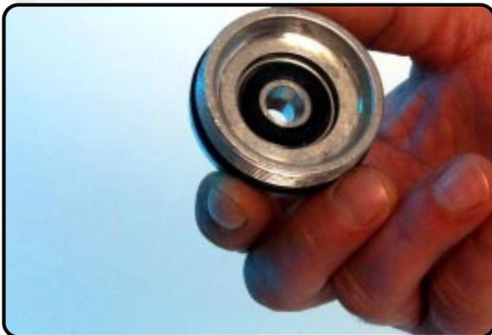
Vérifiez le joint d'étanchéité en caoutchouc interne.
