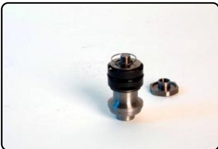
Placez l'écrou et serrez le jusqu'à un couple de 5Nm.
