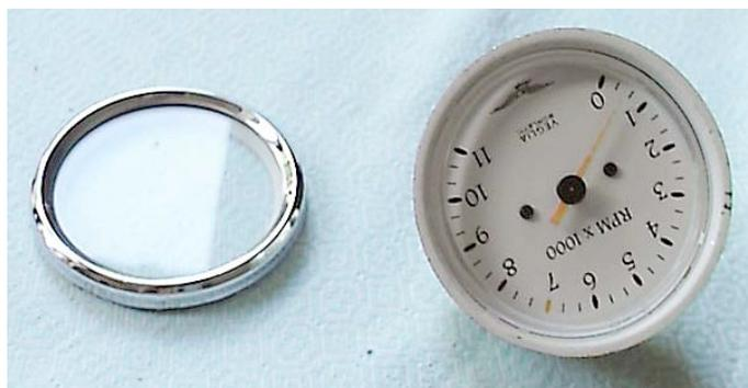
Après avoir dévissé les 3 vis du fond (les 3 grandes sur la photo ci-contre), sorti l'ensemble du cuvelage, retiré l'aiguille (emmanchée à force sur son axe), on peut défaire les 2 petites vis (les 2 petites ci-contre) de la plaque de fond pour accéder à l'électronique.
