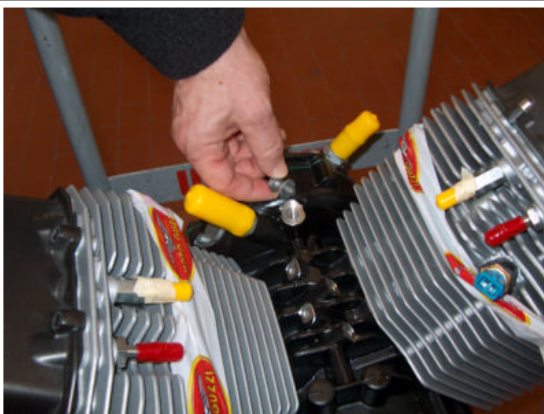
Photo 09 – BOUCHAGE CONDUIT ALIMENTATION HUILE CULASSES
