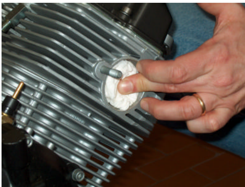
Photo 07 – REMPLISSEZ AVEC DU PAPIER LE CONDUIT D'ECHAPPEMENT
