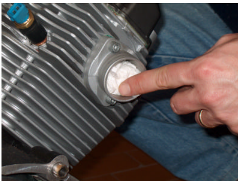
Photo 08 - REMPLISSEZ AVEC DU PAPIER LE CONDUIT D'ADMISSION
