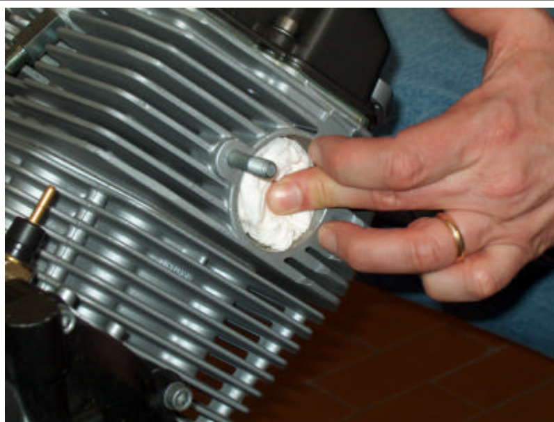
Photo 07 – REMPLISSEZ AVEC DU PAPIER LE CONDUIT D'ECHAPPEMENT
