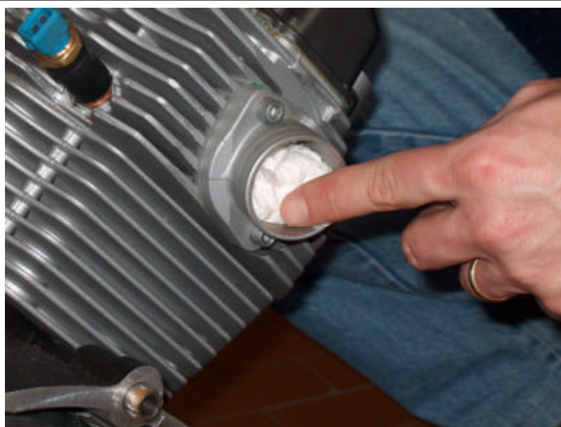
Photo 08 - REMPLISSEZ AVEC DU PAPIER LE CONDUIT D'ADMISSION
