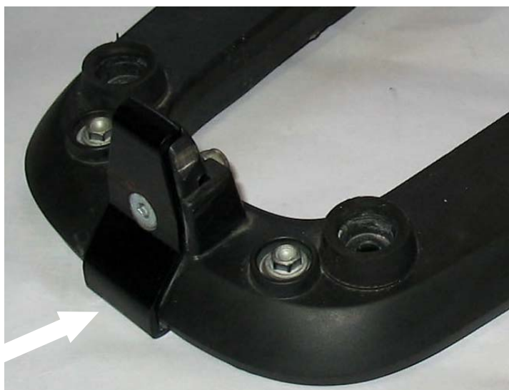
PHOTO 2 - Porte-top-case avec renfort
