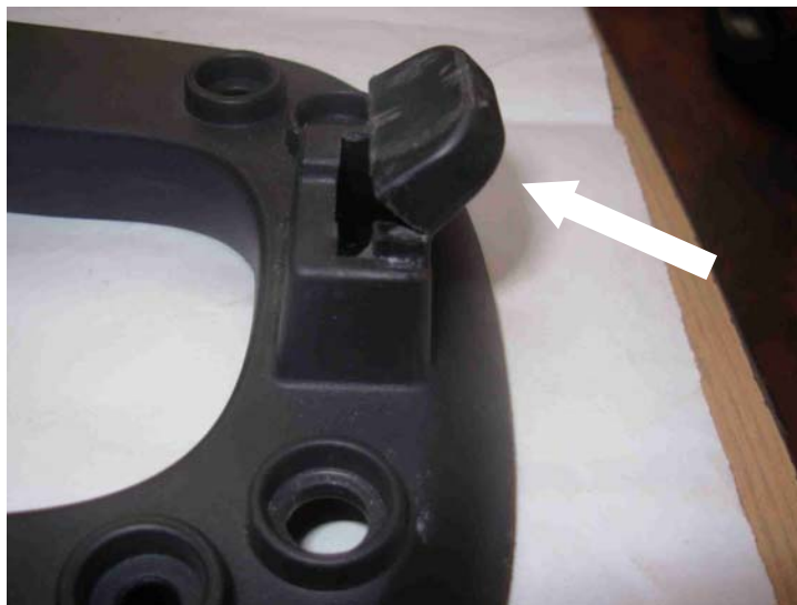
PHOTO 1 – Porte-top-case avec mentonnet brisé
