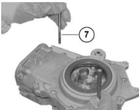
Ensamblar los tornillos de fijación (7).
