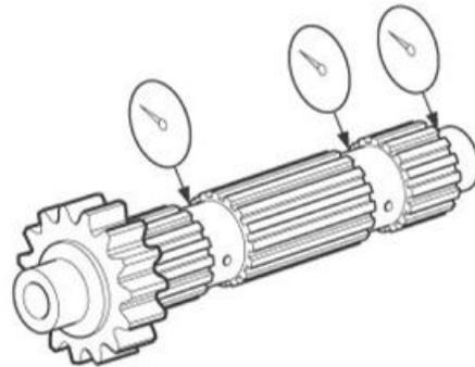
Controlar la presencia de picaduras y desgaste en los engranajes de la transmisión y, eventualmente, sustituir los engranajes defectuosos.
