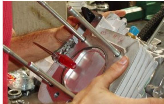
**Utillaje específico****020674Y Pinza para abrazaderas**
