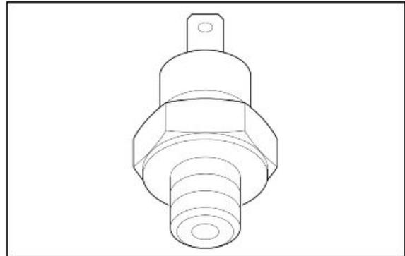
sustituir el interruptor. Si el error continúa, controlar con un manómetro la presión del aceite presente en el circuito del motor
