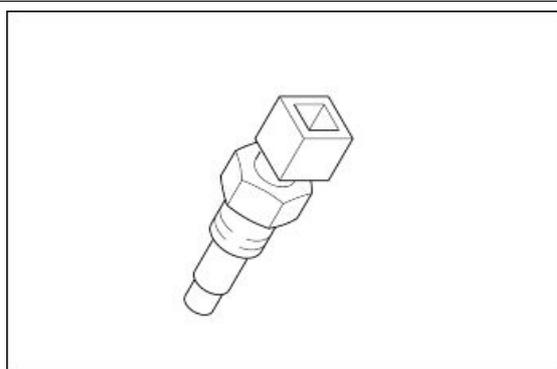
**Características eléctricas:****RESISTENCIA SENSOR DE TEMPERATURA MOTOR**
