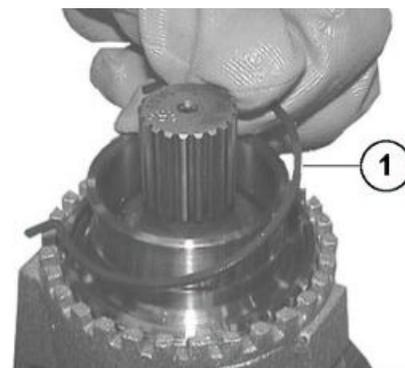
Posición de ensamblaje del anillo de bloqueo (1).
