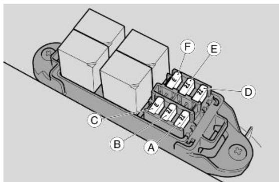
D - Quemador lambda, sensor de velocidad, bobina del relé de inyección secundario, bobina del relé de arranque (15 A).
