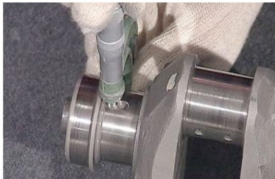
Desviación máxima del paralelismo de los dos ejes del cigüeñal (perno de biela y pernos de banco lado volante y lado distribución) no debe superar los 0,02 mm (in 0.0009), a la distancia de 40 mm (in 1.5748).
