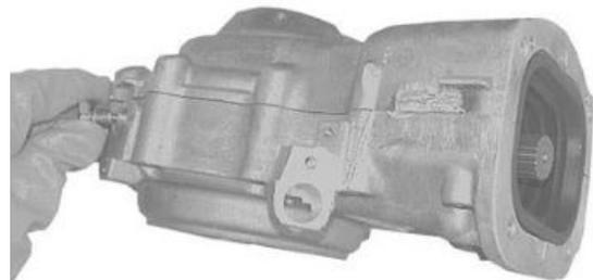
Τοποθετήστε τη βαλβίδα εξαέρωσης με τη ροδέλα.
