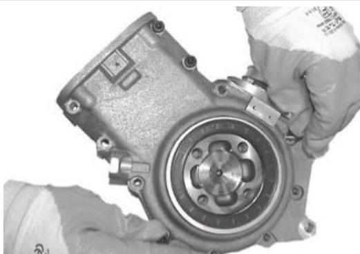
Τοποθετήστε τη φλάντζα στο κιβώτιο.
