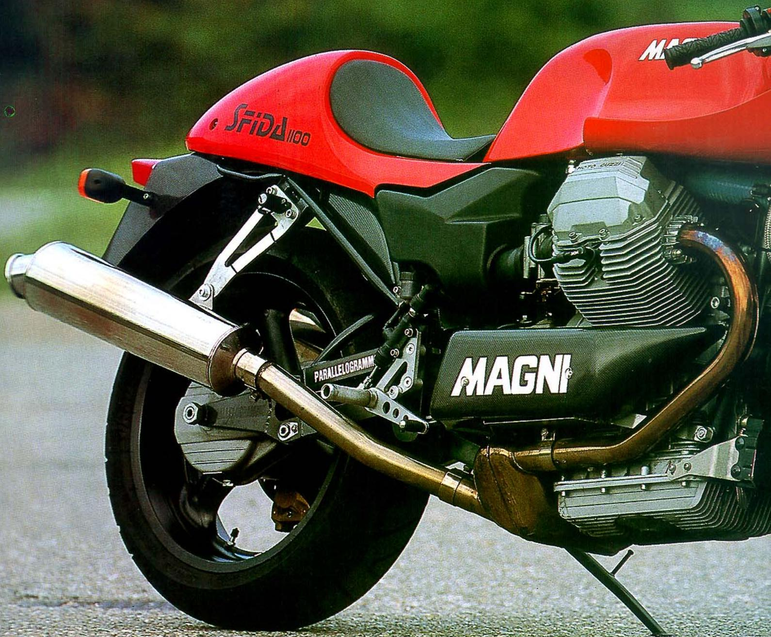
**Suspendu au châssis monopoutre, le deux soupapes Guzzi 1100 reste parfaitement en ligne avec le train avant équipé d'une fourche inversée made in Magni.**
