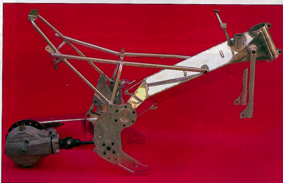
Voici le cadre, façon Gattuso, à l'exécution très soignée. Remarquer le goulot de remplissage soudé en haut de la poutre qui sert aussi de réservoir ; de là, par l'intermédiaire d'une pompe Paioli, le carburant atteint un second réservoir, placé derrière les carburateurs, alimentés par gravité.
