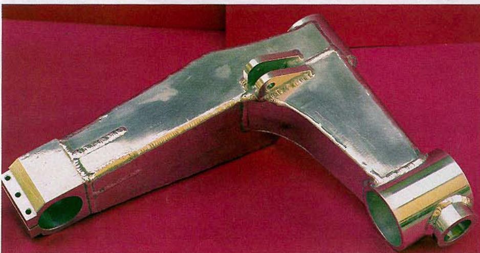
Le bras oscillant est monobras, mais renversé par rapport à ceux qui ont essayé cette solution avant Gattuso.
