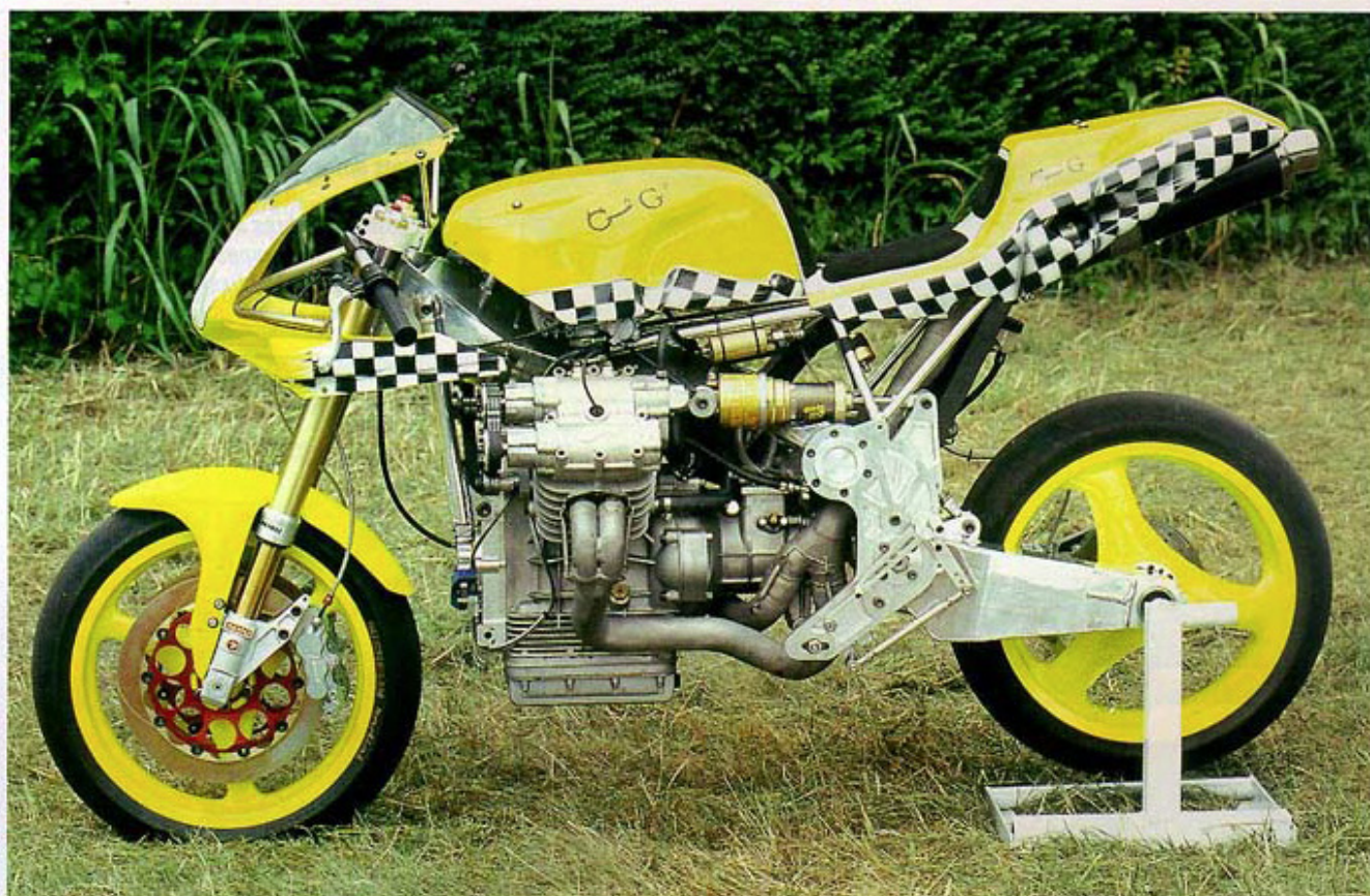
Les vues latérales mettent en évidence la ligne compacte et fine de la moto, qui fait étalage de nombreuses pièces extrêmement techniques. La vue de trois quarts montre clairement la surface frontale réduite, et seules les deux culasses dépassent.
