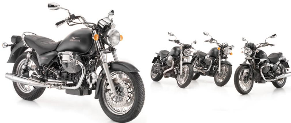
Al grande piacere di guida della Bellagio contribuiscono le eccellenti prestazioni dell'inedito bicilindrico a corsa corta da 935,6cc, che eroga una potenza di 75 CV a 7.200 giri/min. Potenza analoga alla California, ma con un carattere decisamente più sportivo voluto per chi alla guida in souplesse preferisce l'adrenalina di un motore che si esprime al meglio ad alti regimi.
