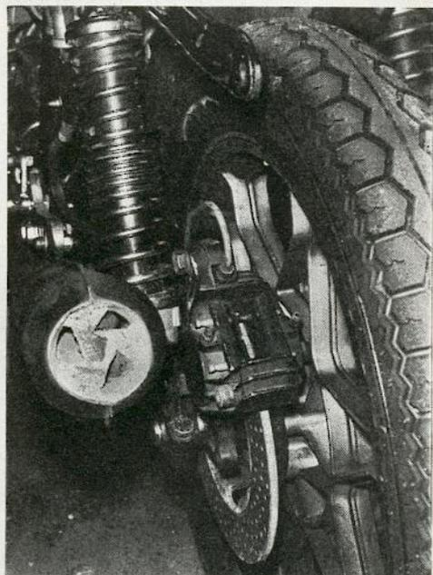
L'étrier Brembo du frein arrière est plus gros que son homologue avant. Il ne peut recevoir qu'une seule qualité de plaquettes, du 334. Pour adapter le niveau sonore au règlement, les sorties des échappements Lafranconi doivent être particulièrement bouchées. Les amortisseurs sont des Le Mans de série.
