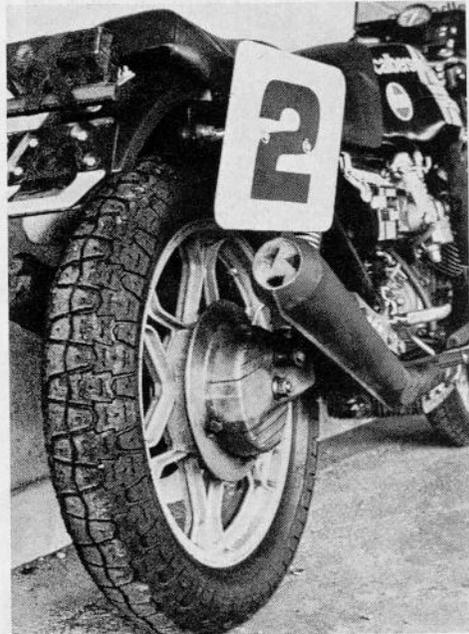
Le nouveau Michelin M 48 ne pouvant être monté sur la Guzzi et le M 45 PZ 2 ne semblant pas lui convenir, c'est avec un Pirelli Phantom sur la roue arrière que nous ferons la course. Un pneu assez tendre manquant un peu de longévité mais dont le comportement est très satisfaisant pour un pneu de série. A l'avant, le choix étant de toute façon limité, la roue est chaussée du fameux Michelin S 41 PZ 2.
