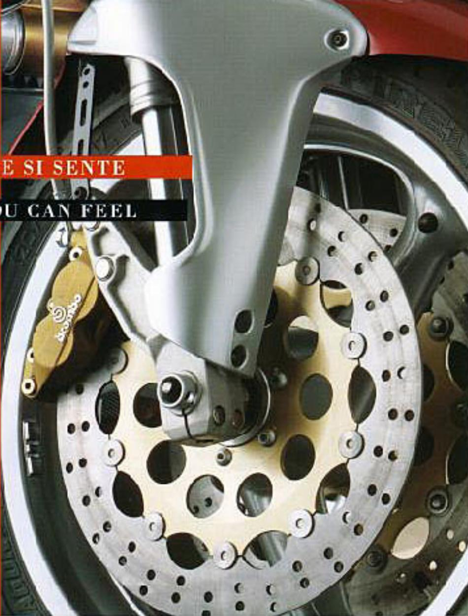
Precisione di guida e confort si avvantaggiano dell'eccellente comportamento delle sospensioni: forcella e monoammortizzatore WP, entrambi ampiamente regolabili nell'idraulica. Mentre la sensazione di totale pacidanza della moto viene rafforzata dalla sicurezza di funzionamento dell'imponente frenante Brembo Serie Oro.
