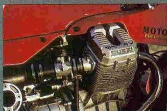
L'injection adaptée sur le V-twin 4 soupapes de la Daytona évite les problèmes de démarrage à froid et apporte une souplesse inconnue sur un twin à carburateur.
