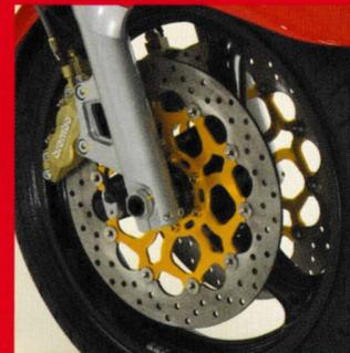
Beeindruckend sind die beiden großen 320 mm Edelstahlbremscheiben der vorderen Bremsanlage. Egal ob im Alltagsbetrieb, bei sportlicher Fahrweise oder mit viel Gepäck auf großer Tour - zusammen mit den beiden 4-Kolben-Zangen sorgen sie jederzeit für sichere Verzögerung. Das Hinterrad wird wirkungsvoll über eine 282 mm Edelstahlbremscheibe mit schwimmender Doppelkolben-Zange gebremst.
