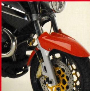
Die extrem gut ansprechende, massive 45 mm Teleskopgabel garantiert absolute Spurstabilität und präzises Lenkverhalten. Individuell kann die Federvorspannung auf den persönlichen Fahrstil und die Straßenbedingungen abgestimmt werden. Der sportliche Look der Brevia V 1100 wird durch die in die vordere Radabdeckung integrierten Gabelrohre noch unterstrichen.
