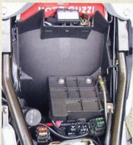
**OPTION BASSE** Sous la selle, un emplacement pour un U, la valve de purge de l'embrayage, l'équipement électrique, une petite trousse à outils, le gros manuel de la Norge et une prise 12 V. Guzzi propose en option une selle basse de 760 mm, soit 40 mm de moins que celle d'origine.
