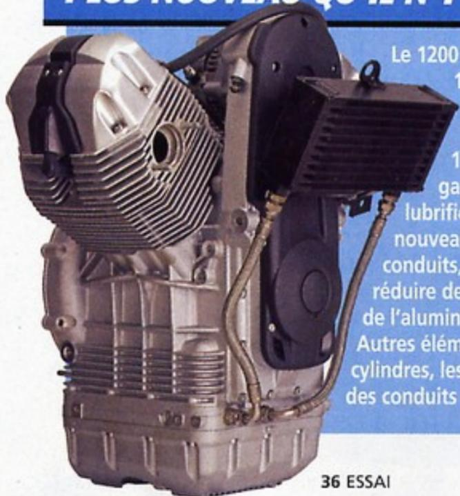
Le 1200 Norge (exactement 1151 cm<sup>3</sup>) accueille soixante nouvelles pièces par rapport au 1100 et 9 ch ont été gagnés. Le système de lubrification est tout nouveau, de la pompe aux conduits, ce qui a permis de réduire de 14 °C la température de l'aluminium de la culasse. Autres éléments nouveaux: les cylindres, les bielles et le diamètre des conduits d'admission.
