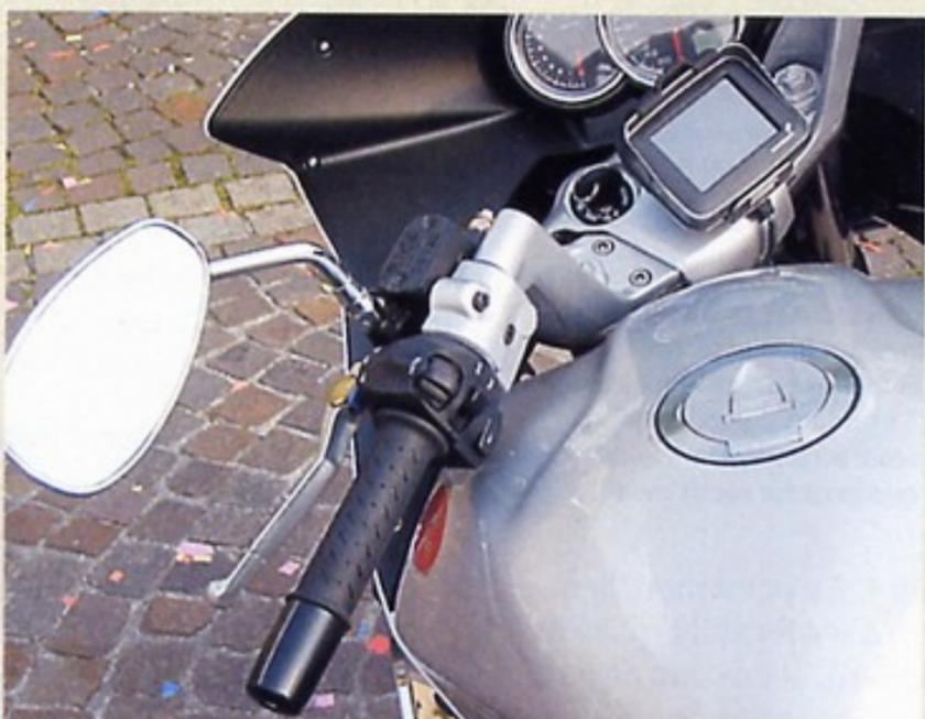
**AU DEGRÉ PRÈS** La température des poignées chauffantes se règle au moyen de la gâchette située sous l'appel de phare (température indiquée au tableau de bord).
