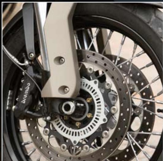
La Stelvio 1200 NTX est une voyageuse qui mêle les qualités d'une moto tout-terrain aux performances d'une vraie routière. Son secret réside dans un châssis à double poutre supérieure qui vient se fixer au moteur via six points de connexion. Cette architecture apporte une grande rigidité au châssis. Au raffinement de la boîte et des suspensions vient s'ajouter un système de freinage Brembo avec ABS de série, pour une sécurité optimale en toutes conditions.
