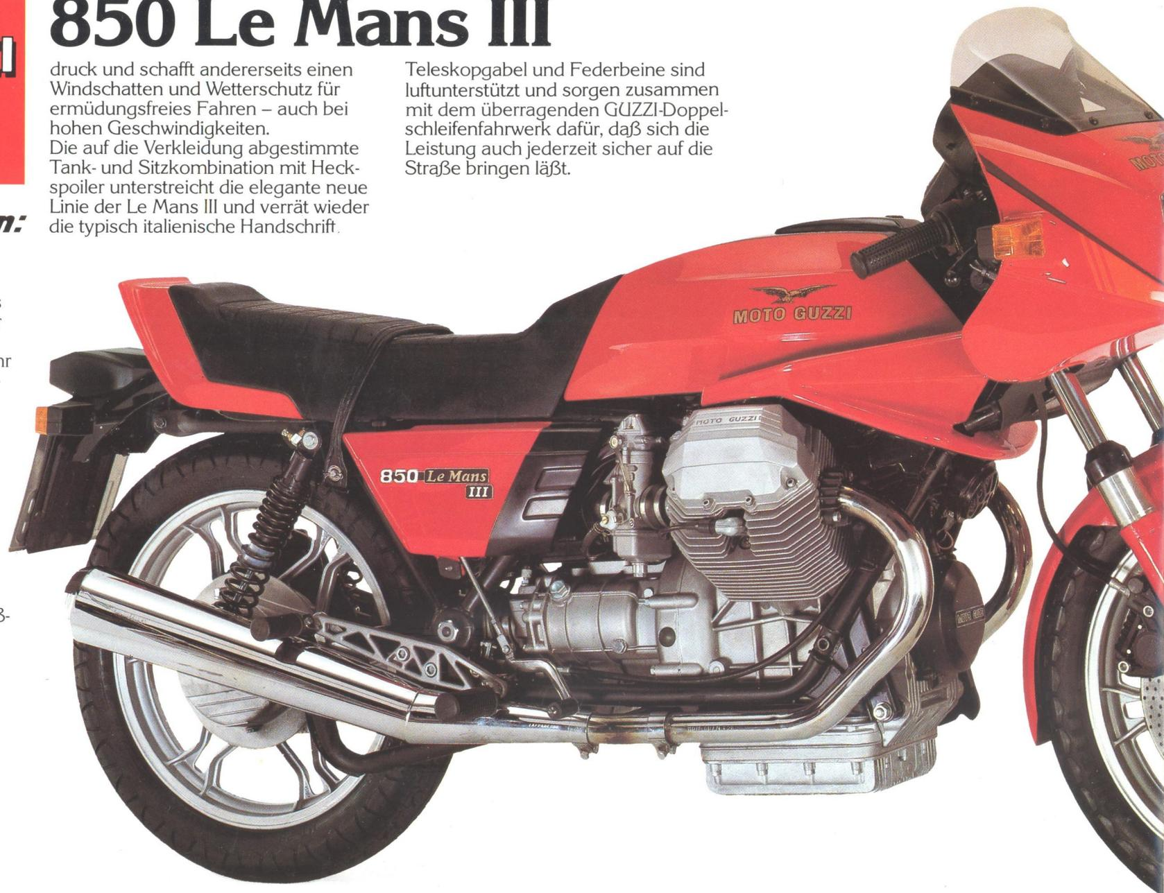
Mit dem in vielen wesentlichen Details überarbeiteten, bewährten 850-ccm-V-Motor realisierte GUZZI den modernsten Stand seiner technischen Entwicklung. Unter anderem durch dickwandigere Zylinder mit Nigusil beschichteten Laufflächen, durch ein verstärktes Motorgehäuse, durch eine Luftfilteranlage mit neuem Ausgleich-
