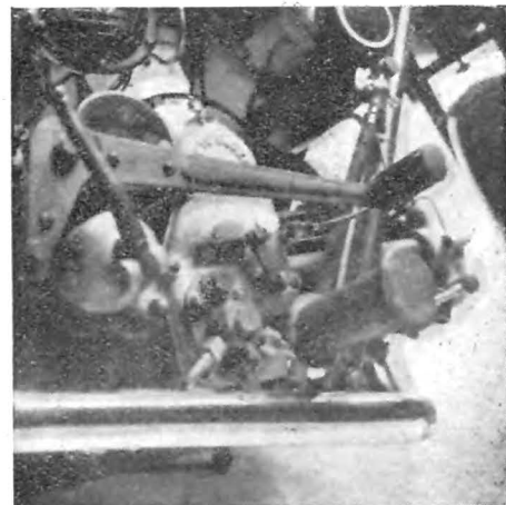
Pedale del cambio e pompa dell'olio, protetta dal tubo di scarico nell'« Ardetta ».
