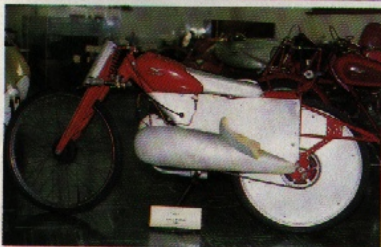
Le 65 des records de 1946-47 : très proche de la série à ceci près que le pilote est à genoux au dessus du réservoir avec le guidon au niveau des tés inférieurs de fourche et les repose pieds derrière la moto !
