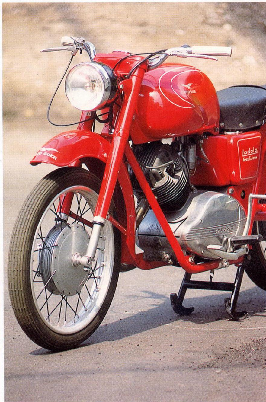
me necessario con una primaria a due ingranaggi e un cambio in presa diretta), la lubrificazione è sempre a carter secco, con pompa doppia di mandata e ricupero e serbatoio dell'olio separato, e l'asse a camme in testa agisce sui bilancieri attraverso il rullo, tanto caro a Carlo Guzzi.
